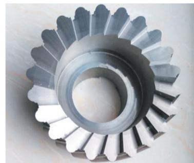
平面前刀面圆弧齿刚齿刀具
