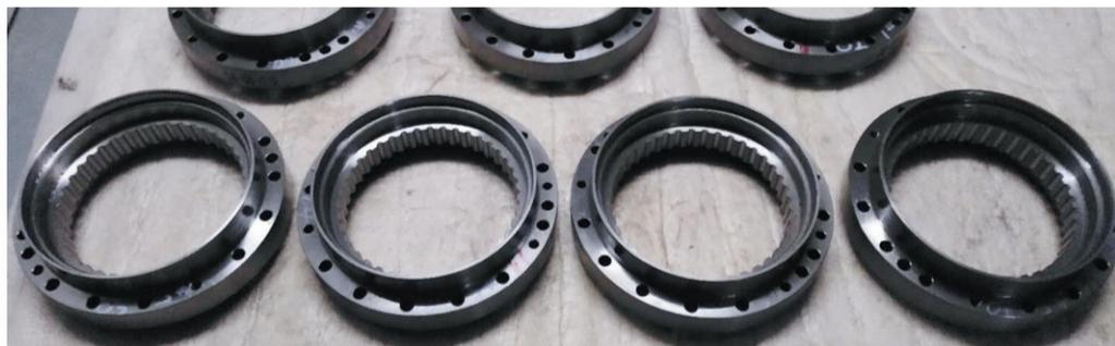
刚齿加工完成的零件
