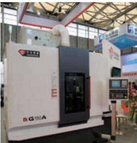
最大工件直径150mm, 最大加工模数3mm, 滚刀主轴最高转速2000r/min, 螺旋角范围±45°, FANUC Oi-MF/H数控系统, 六轴四联动, 最高加工精度6级。还具有轴向鼓形齿、锥度齿、径向法蜗轮以及硬齿面齿轮加工和干式切削加工能力, 具有二次对刀、自动窜刀、柔性同步、会话式编程等功能, 可与自动上下料装置配合完成连线加工。
