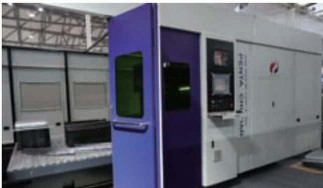
加工幅面3000mm×2000mm, X、Y轴定位精度0.05mm/m, 重复定位精度±0.02mm, A、B轴重复定位精度±10"。X、Y轴最大定位速度30m/min, 最大加速度0.8g, A、B轴最高转速60r/min。机床采用意大利Penta研发的Smart Manager 4.X操作软件, 具有可优化空间轨迹的RTCP功能和可自动检测切割头与被加工件(金属板材)之间距离的功能。
