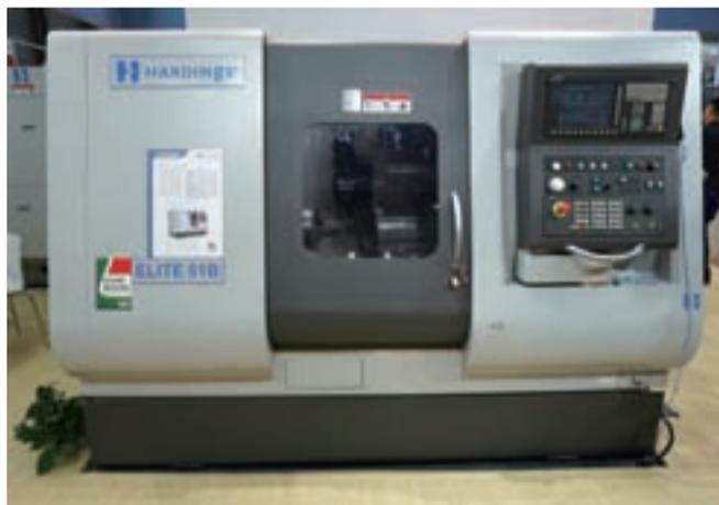
最大加工直径310mm，主轴转速5000r/min，主轴棒料通过直径42mm，主轴功率11kW，数控系统为FANUC 0i-TF。哈挺ELITE家族最新系列高精度车削中心，功能完备，配备哈挺传统夹头式主轴，可以得到更高的精度，优秀的抗震性和热稳定性。带来出色的零件圆度、表面质量、尺寸稳定性，并力求刀具寿命的提高。
