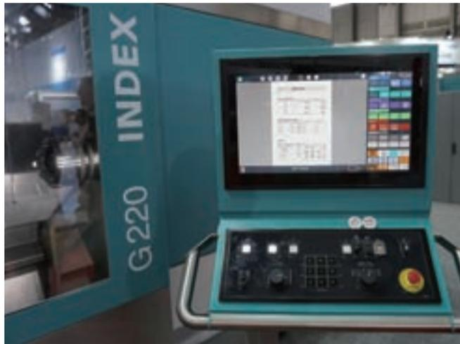
两者可方便快速的创建多种加工数控程序，优化的路径和刀具应用策略可显著提高切削率，减少刀具负荷，提高刀具寿命。VirtualLine虚拟机床（VM）软件，含有INDEX机床的全部功能，可在机床和CAM系统中进行与物理机床行为一致的模拟，包括程序检查、碰撞检测、切削仿真。软件使用方便简单，具有所有机床刀架、主轴和刀具的3D设计模型，按需调用。
