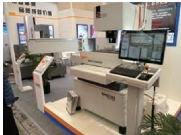
本产品嵌入式控制系统, 可实现与CAD无缝连接, 兼容UG/SOLIDWORKS/AUTOCAD等绘图软件的DXF图形, 具有“互联网+”功能, 可实现远程实时监控, 具有智能化数据库并且定期免费更新。可选配C轴, 为一些特定产品的小孔加工提供了解决方案。搭载宝玛具有完全自主知识产权的穿孔机编控系统, 加工工作中可同时绘图编程。
