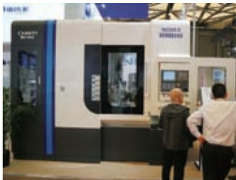
高精度、精加工精度为GB 10095.1-2008的6级；高效率：生产效率是湿式、单序加工的2~3倍，适合大批量生产；配备自动化上下料机构；机床控制为八轴数控四轴联动，数控系统为Fanuc31i；机床刀具主轴采用电主轴直接驱动，工件主轴采用力矩电机直接驱动，确保传动系统的刚性及精度。
