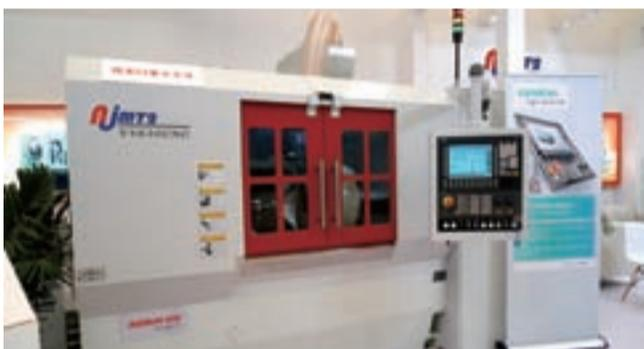
七轴五联动, 机床主轴及工件主轴采用直驱技术, 工作台轴向进给采用直线电机驱动, 宜人化的操作界面及自主知识产权的用户软件, 具有自动余量补偿、夹持力控制、自动热变形补偿、恒力切削、工件相位检测、自动对齿等智能功能。加工精度5~6级, 齿面粗糙度值Ra在0.63 μm以下, 使用西门子840Dsl数控系统。
