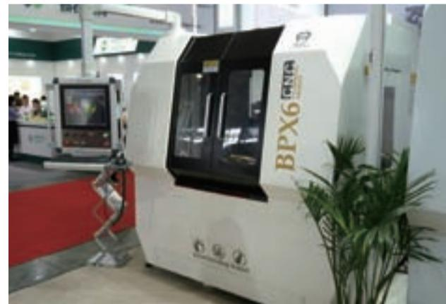
X、Y、Z、A、B六个主控轴, 全闭环控制, 直线轴由直线电机驱动, 回转轴直驱电机驱动, 采用双端磨头磨削工件外圆, 具有自动上下料装置, 搭载自主研发的磨削软件, 界面友好, 内置多种标准刀具图形, 通过参数输入即可轻松完成编程。
