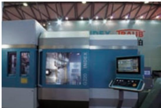
使用中对于设备灵活性的要求。动力强劲且功能强大的电主轴适用于对生产高要求的工具，适用于五轴加工。此外，具备强力驱动的下刀塔带有Y轴，确保了配合主轴及副主轴进行三维加工的能力。
