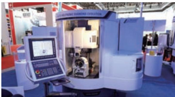
磨削直径范围1~165mm，整体磨削工件最大长度185mm，外圆磨削工件最大长度255mm，端面磨削工件最大长度185mm。在一次装夹的情况下能够自动完成复杂刀具几何形状的电解加工（EDM）和磨削加工。内置的专家工艺系统，具有3D仿真模拟、碰撞检查等智能功能。
