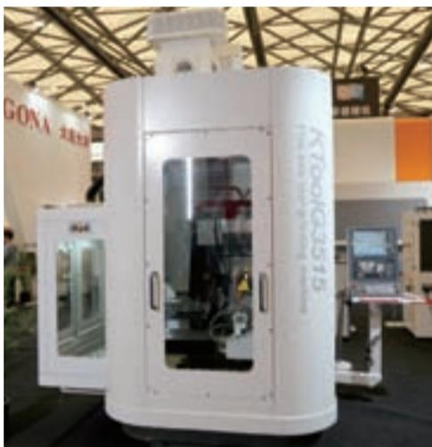
最大工件直径350mm, 最大棒料工件长度350mm, 最大工件重量50kg, 定位精度0.008mm, 重复定位精度0.004mm, 分辨率0.0001mm, 回转轴定位精度0.004°, 重复定位精度0.003°, 分辨率0.0001°。搭载自主研发的GNC61总线式数控系统和G-TOOL磨削工艺软件系统G-TOOL, 适应多种刀具的磨削加工, 并可选配多种自动化装置, 实现无人作业。
