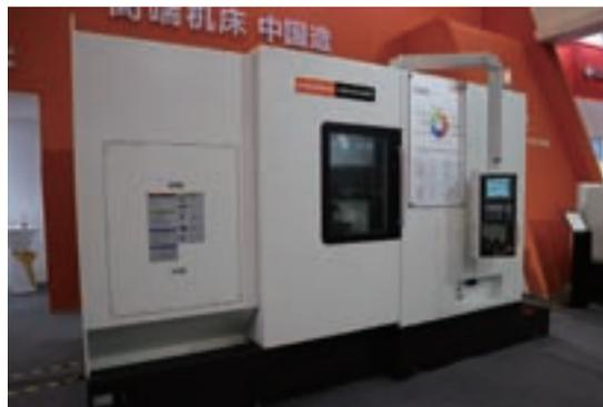
镗、钻、攻复合并行加工。它的特点：高精度结构设计和配置；车铣复合顶置式正交结构；多项前沿技术、创新设计；X、Y、Z轴全闭环控制；主轴冷却及负压防护系统；双通道数控系统等。
