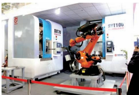
齐重数控装备股份有限公司展出的SVT70/100 G-NC柔性制造单元，以两台数控立式车床为主机，以大悬臂六关节机器人完成工件的输送与搬运，适用于轿车铸铁轮毂、铝轮毂的自动化生产。
