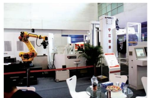
四川普什宁江机床有限公司展出的FMS63柔性生产线，由卧式加工中心、具备零件识别功能的智能机器人、自动输送小车以及8工位双层托板库等组成，在展会期间进行了阀体类零件的混流加工演示。
