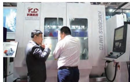
达到理想的静态和动态特性。企业自主研发的KMC800 U系列高速五轴立式加工中心是装备制造制造业重要的基础性设备，具有举足轻重的战略意义，尤其在航空、航天、能源、军工等领域加工大型复杂零部件，如发动机机匣、整体叶盘、涡轮转子、复杂轴盘类以及精密刀具类零件的加工。
