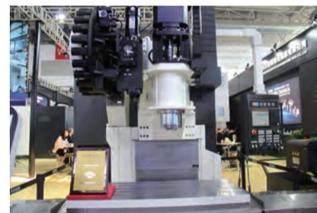
配12000r/min直联式主轴可满足客户的高速切削需求；三轴快移速度高达40m/min，加速度为0.6g；定位精度高达0.006mm，重复定位精度为0.004mm，保证了机床加工精度的高精密度。
