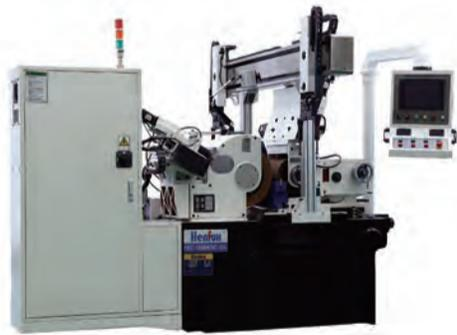
CIMT2019重点展示生产连线产品。两台高精度数控无心磨床搭配托盘智能上料机、连线转料机、在线清洗风干测量分选机和零件装盒机组成,满足各种轴类零件成形研磨贯穿式磨削、外径检测、零件分选、外径自动调整,集中装盒等诸多工序。同时具备测量补偿、砂轮修整补偿、导轮修整补偿、计数补偿、校正补偿等外径稳定功能,适用于大批量产品的磨削加工,可一人管理多个研磨单元,极大地提高生产效率,解决人力难题。
