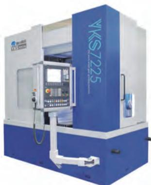
YKS7225数控蜗杆砂轮磨齿机采用连续展成法磨削原理的数控蜗杆砂轮磨齿机，配备SIEMENS 840Dsl数控系统，可实现从工件自动装夹、自动对刀、自动磨削及自动修整过程的全自动控制，特别适用于汽车、减速器等行业中大批量渐开线圆柱齿轮的精密磨削。
