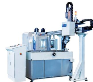
检测、全闭环控制、对话界面等功能。搓齿最大模数1.0mm、搓齿最大宽度40mm、工件最大长度400mm、装刀规格13或16inch。
