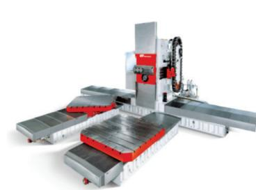
DS1200/450C 数控镗铣加工中心 X/Y/Z 轴行程为 7500 ~ 11500/2400/2200mm；数控平旋盘 (U 轴) 行程 450mm，最高转速 100r/min，电机功率 37kW，最大扭矩 16956Nm；最大工件直径  $\Phi 2500\text{mm}$ ，最大车削直径  $\Phi 2000\text{mm}$ ；卧式镗铣主轴 (W 轴) 主轴直径  $\Phi 280\text{mm}$ ，电机功率 37kW，最高转速 2000r/min，W 轴 (数控滑枕)
