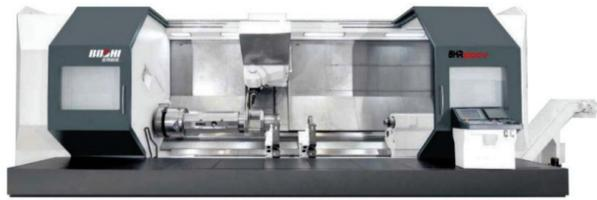
是一款五轴联动卧式车铣复合加工中心，床身上最大回转直径  $\Phi 820\text{mm}$ ，车削主轴最高转速 2700/1680 r/min，铣削主轴最高转速 5000 r/min，B 轴摆动范围 -110° ~ 90°。机床配置有 X、Y、Z、B、C 五轴；主轴箱采用双电机主从模式，连接齿轮箱，两档变速，主轴输出最大扭矩 3340Nm，主电机功率可选择，主轴夹紧力可调；采用独立仓储式刀库，配备机器人实现刀具及附件头的快速更换；可实现各种车、铣、镗、钻、铣齿、磨等复合高精加工，擅长于深孔加工，最大加工孔深可达 1500mm，应用于能源领域、航空航天领域、大型船用柴油机领域的传动轴等加工。
