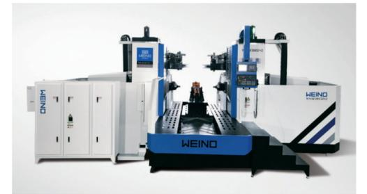
复合双面铣镗加工中心工作台移动行程(X 轴) 2000mm, 滑座移动行程(Y1/2 轴) 1100mm, 滑枕移动行程(Z1/2 轴) 600mm。X/Y1/2 轴定位精度  $0.015/1000\text{mm}$ , Z1/2 轴定位精度  $0.020\text{mm}$ , 主轴最高转速 6000r/min。床身、工作台、滑鞍、立柱、滑枕等大件均采用高强度铸铁材料, 树脂砂工艺造型, 两次时效处理消除应力, 应用三维设计软件和有限元分析软件进行优化设计。主要用于加工挖掘机动臂、挖掘机的斗杆、高速冲床的横梁、挖掘机的下车、坦克的下车、动车转向架的转臂定位、齿轮减速机对称性的零件, 可在一次装夹中连续完成铣、钻、扩、铰、镗、攻丝等多道工序。
