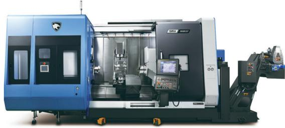
PUMA SMX2600ST 铣车复合加工中心, 卡盘尺寸 10 英寸, 最大车削直径  $\Phi 660\text{mm}$ , 最大车削长度 1540 mm, 共有 9 个轴, 采用正交型 Y 轴结构, 左右主轴及铣削主轴组合, 铣削主轴安装在摆动 B 轴上, 配备 12 位高刚性伺服刀塔, 具有强大的切削性能。结合左右主轴、B 轴铣削功能和下刀塔, 具有更高的多任务处理能力, 适用于复杂零件和高精度要求零件的加工。采用人体工程学设计, 前置刀库及触屏式 ATC 操作面板, 更加便于操作和维护修理。
