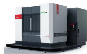
J5MB1112 卧式铣镗加工中心镗轴直径  $\Phi 110\text{mm}$ , 立柱横向行程(X 轴) 1750mm, 主轴箱垂直行程(Y 轴) 1250mm, 工作台纵向行程(Z 轴) 1600mm, 镗轴轴向行程(W 轴) 500mm, 镗轴低速最大扭矩 1150Nm。采用 T 型床身, 动立柱, 正挂式主轴箱结构, 配置静压转台, 全闭环控制。主轴箱采用齿轮变速传动和液压氮气平衡机构, 各传动轴系独立恒温冷却系统, 链式刀库和自动排屑装置, 自制高刚性高精度镗轴单元, 配置整体全封闭式或半封闭式双开门防护罩, 适合对箱体类、壳体类、模具类零件高精度孔系和平面加工。
