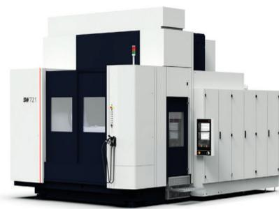
BA 721 Space 是 SW 全新设计的双主轴单工作台卧式加工中心，首次在中国展出。机床床身采用整体式框架结构，Y轴采用龙门式驱动，加工单元采用“框中框”结构，主轴采用 HSK A100。直线轴配有滚珠丝杠，回转轴配有力矩电机。X轴和 Z 轴可选独立运动。SW 研发了用于其数控加工中心的新型 Clone 控制面板，该面板采用专项研发新技术，并拥有诸多优势：采用 SW 新型设计的细长型铝壳不仅高度可调节，使其更符合人体工学，而且还配备旋转枢轴，确保机械加工的同时，所有运行过程均处于操作人员的视野范围内。
