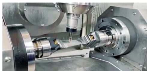
X/Y/Z 轴行程 500/300/450 mm, B 轴旋转角度  $\pm 40^\circ$ 。主要用于航空发动机、燃气轮机的高温合金、钛合金精密叶片的高速高效精密加工。配备高精度高刚度电主轴, 五轴全闭环控制; A 轴模块化设计, A 轴夹具采用
