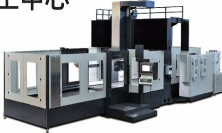
FP-40/40 龙门式五面体加工中心是一款高精度、高刚性的五轴龙门加工中心，在加工曲面及结构面比较复杂的工件时，可实现五轴联动，能够一次装卡完成各部位的重切削及半精密加工。X/Y/Z 行程 4000/3000/1000mm，立柱间距 2500mm，主轴最高转速 6000r/min；最大输出功率/扭矩 30kw/1045Nm。大尺寸整体结构设计和精密部件确保具备良好的精度保持性，所配备的各类万能铣头和双摆角铣头，确保适用于各种复杂零部件的精密多面体加工。
