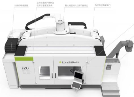
FZU32 五轴联动龙门加工中心是一款紧凑的高架横梁移动式五轴联动龙门加工中心，采用热对称结构，八边形滑枕，中心驱动方式，模块化设计，满足不同用户的加工需要。X 轴行程 2000/4000/6000mm 可选，Y 轴行程 3000mm，Z 轴行程 1250/1500mm 可选，A 轴转动范围  $\pm 110^\circ$  或  $-95^\circ \sim 125^\circ$  可选，X/Y/Z 轴进给速度 60m/min，A、C 轴进给速度 30r/min。用于加工铝、复合材料、塑料、聚氨酯和粘土等非金属材料。
