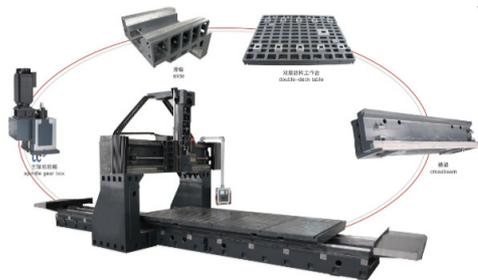
选配全闭环控制、刀具检测和工件检测系统。主轴系统及高速齿轮的冷却采用油冷机冷却。
