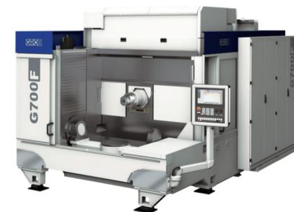
X/Y/Z 轴上的行程 1450/990/1035 mm, 最大速度 60/75/100 m/min, 最大加速度 0.65g/0.55g/1.4g, 最大工件直径  $\Phi 1500\text{mm}$ 。专为加工轻量化的框架结构件、大尺寸底盘工件而设计, 适合汽车工业的副车架、动力电池外壳、电池底座、纵梁和减振支架等零部件的加工, F 系列均为五轴卧式加工中心。
