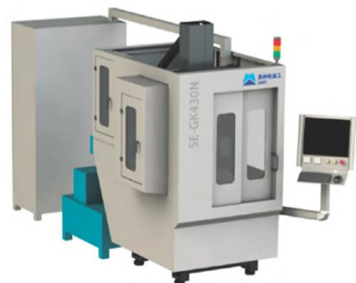
该展品是为航空航天发动机制造业研制的专用设备。主要用于发动机叶片、安装边、环形件、火焰筒等零件材料特殊、空间位置复杂的小孔加工。加工孔径一般在 Φ0.2–Φ3mm, 可加工扇形孔、腰形孔, 可配置 X、Y、Z、W、B、C 六个数控轴; 电极转速可调范围 0–800r/min, 加工中可自动修整电极, 自动找加工零位, 自动换基准, 可配电极库和导向器库, 支持自动更换, 具有穿透检测功能, UG 编程加工, 全新高频脉冲电源, 加工效率更高。
