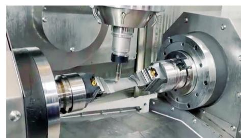
X/Y/Z 轴行程 500/300/450 mm，B 轴旋转角度 ±40°。主要用于航空发动机、燃气轮机的高温合金、钛合金精密叶片的高速高效精密加工。配备高精度高刚度电主轴，五轴全闭环控制；A 轴模块化设计，A 轴夹具采用 BT50 快换接口，提升加工产品换
