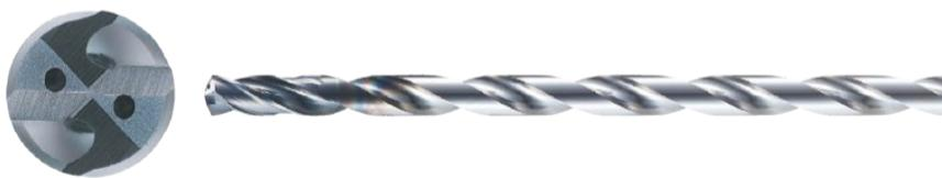
排屑不良是小径深孔加工时的常见问题。微小的切屑容易堆积在刀具外周，是导致刀具突发折损的关键原因之一。欧士机推出小径内冷油孔硬质合金钻头，实现兼顾稳定和高效的小径深孔加工。即使是深孔也能进行无阶梯式加工，实现高效率加工，相比传统的阶梯式钻孔，提高约 9 倍的加工效率。
