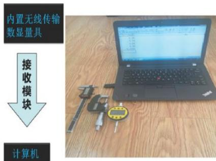
自主开发的具有内置无线传输模块的电子量具系列产品（包括数显卡尺，数显千分尺，数量指示表等）。该无线量具及数据管理系统具有几大特点：
