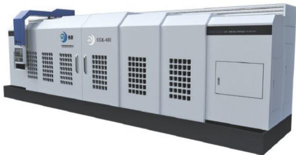
该机床集机、电、光多项高新技术于一身，构思巧妙，设计新颖。采用后置式垂直导轨布置，提高加工刚性，采用气压冷却便于加工切屑流向及输送，导轨安装不锈钢鳞片式铠甲护罩。
