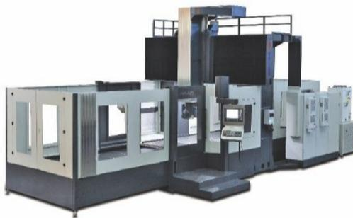
FP-40/40 龙门式五面体加工中心是一款高精度、高刚性的五轴龙门加工中心, 在加工曲面及结构面比较复杂的工作件时, 可实现五轴联动, 能够一次装卡完成各部位的重切削及半精密加工。X/Y/Z 行程 4000/3000/1000mm, 立柱间距 2500mm, 主轴最高转速 6000r/min; 最大输出功率 / 扭矩 30kW/1045Nm。大尺寸整体结构设计和精密部件确保具备良好的精度保持性, 所配备的各类万能铣头和双摆角铣头, 确保适用于各种复杂零部件的精密多面体加工。
