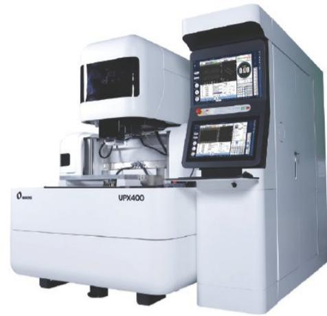
UPX 机床作为牧野中国首发全球的高端线切割机床，其含义是：UPX “UP To X，重新定制行业标准”。该机型延续了前代机床的超高刚性床身设计，采用“矩阵式校正”，可以对床身台面任意位置做精准定位。针对用户多排电机转子的模具，不仅全行程位置度精准，回转电机转子模具回转直径上的精准定位，而且确保转子零件高速旋转时的动平衡。
