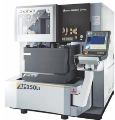
沙迪克本次 CIMT2023 带来了 AP250Ls (oil) 线切割放电加工机床, 其最大工件尺寸 270×400×100mm (长×宽×高), 最大锥度 ±7° (零件厚度 100mm), 电极丝径 0.03–0.2mm, 电极丝张力 3 ~ 18 N, 最快电极丝进给速度 250mm/s。采用直线电机驱动以及低重心门型结构, 可大幅提高准备工作效率的三面自动门液槽和“コ”工作台设计, 具有高热稳定性的开机即可高精度加工的液冷却装置以及空气循环系统, 高速高精的可使油介质实现与水电介质相同切割速度的“ECO CUT O-Plus”技术 (粗糙度 Ra
