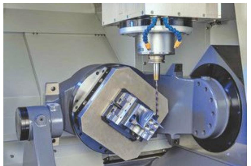
VERSA745 精密立式五轴加工中心采用龙门式结构,主轴转速最高 30000 r/min, X/Y/Z 轴行程为 500/650/420mm。摇篮式力矩电机驱动的旋转工作台沿 X 轴集成,有利于快速五轴联动铣削,以及超高定位精度的五轴加工。灰铸铁床身加上热对称结构设计,保证了机床刚性和精度。机床立柱结合面,导轨结合面等所有安装面采用人工刮研工艺,几何精度完全由人工机械方式刮研、调整保证,保证长期坐标镗床级的精度。可配 Fehlmann MCM 铣削系统,控制机床运行和自动上下料及刀具破损检测,满足无人值守。
