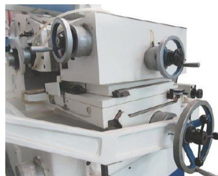
$20 \sim 25\text{ kg/cm}^2$  高压油膜，使主轴悬浮于其中，保证了主轴工作精度及工作寿命；上滑板配合燕尾式滑轨，下滑板采用双  $\Lambda$  型导轨，提供平滑且精准的进刀，上滑板具有  $+6^\circ \sim -5^\circ$  的调节范围，用于调整砂轮和工件之间的接触面。提供定制化的自动收料系统，适合不同工件的自动化加工，适用于大批量、重切削、高精度、复杂外形的轴类件加工需求。
