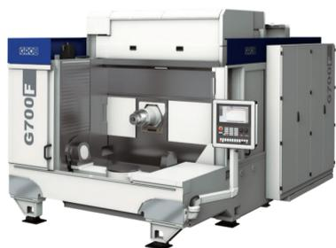
X/Y/Z 轴上的行程 1450/990/1035mm，最大速度 60/75/100m/min，最大加速度 0.65g/0.55g/1.4g，最大工件直径 Φ1500 mm。专为加工轻量化的框架结构件、大尺寸底盘工件而设计，适合汽车工业的副车架、动力电池外壳、电池底座、纵梁和减振支架等零部件的加工，F 系列均为五轴卧式加工中心。
