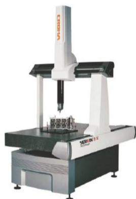
该系列测量机采用国际技术标准，价格在进口设备同标准的条件下，下降50%，这与国内制造业客户普遍追求降本的理念一致；由于活动桥架的结构设计独特，比重轻，设备运行的速度和加速度高，比如在当时就推出了空间速度520 mm/s，加速度：1730 mm/s<sup>2</sup>，当时国内大部分测量机空间速度仅在250 mm/s，加速度在500~800 mm/s<sup>2</sup>；CROMA测量机具有优异的品质和高保值率，选择该机型的客户，基本都是在三年以上才会做一次精度维护保养，给客户省去大一笔售后维护费用；整机平均寿命和保值率加高。思瑞从一开始推出定制化的PC-DMIS BASIC和PREMIUM两个模块，简单易学，同时核算算法和先进的测量软件保持一致，软件的接口和应用模块，都灵活和高效地满足了各领域的客户需求。
