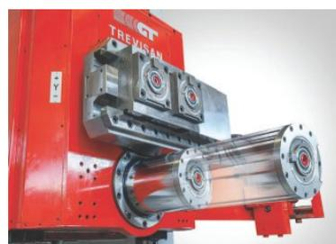
配备数控 W 轴和平旋盘 (U 轴) 是该设备的最大特色，提高了机床的性能，增加了功率。W 轴行程 350mm，U 轴行程 200mm，最大车削直径  $\Phi 250\text{mm}$ ；X/Y/Z 轴最大行程为 2000/1500/1600mm。基本一次装夹就可完成工件几乎所有加工面和工艺的加工要求，具备高效，安全，安装精度可控的特点。
