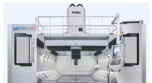
（2）该机主要特点是桥架式动梁机床结构，刚性好、吸震性强、加工范围大、稳定性好、动态特性佳。X、Y、Z 轴均采用高速滚珠丝杠传动，且 X 及 Z 轴均采用双丝杠驱动，采用双轴同动技术实现同步控制，可大大增加直线轴的加速力矩，提高动态响应特性。五轴铣头 A、C 轴均采用大扭矩力矩电机直接驱动，旋转速度高，无磨损，精度保持性好。
