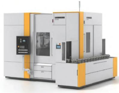
LGG280 基本参数: 最大工件直径 280mm, 工件最大转速 3000r/min, 最大轴向行程 660mm, 最低加工位置 (工作台以上) 90mm, 磨齿头摆动角 ±45°, 带副立柱的机床重量约 13t, 总设备功率约 32kVA, 最大加工轴件长度 500mm。
