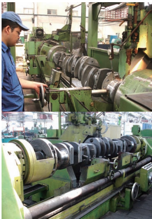
图5 机械同步轴传动和电机伺服同步传动曲轴磨
