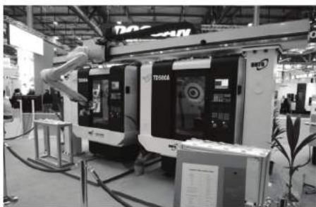
图 17 大连机床集团机器人与数控车床及加工中心组成的柔性生产线
