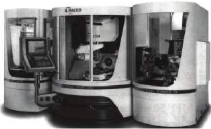
图 15 联合磨床集团公司刀具磨削单元
