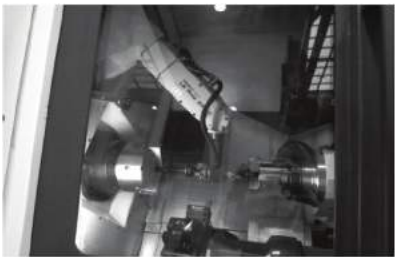
图 16 斯宾纳公司机器人融入数控车床内部的柔性单元
