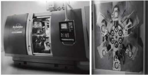
图1 德国 Schutte 公司 SCX-32 型 6 轴卧式多刀自动车床
