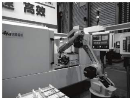
图4 MK1320A—3X500 数控外圆磨床集成工业机器人
