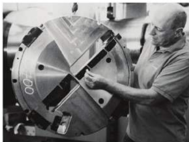
图4 用于实体直接钻孔700mm直径的Botek typ 43型深孔加工刀具
