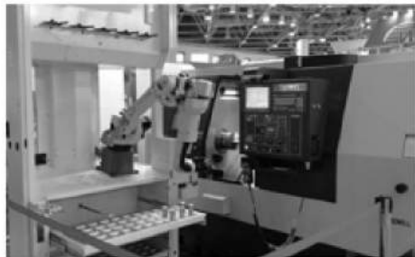
图 19 两台数控车床与机器人组成柔性加工单元，机器人安装在过桥上，操作者与机器人有效分隔
