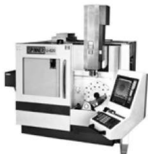
图8 U620 立式五轴加工中心
