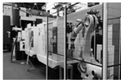
图 18 日本 FANUC 公司为机床上下料的机器人
