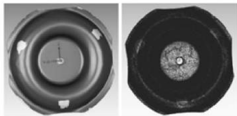
图4 点云数据封装后得到的三角网格面
