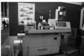
广宇大成配置 HNC-808 数控系统的 20H 精密数控外圆磨床
