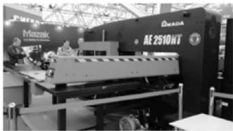
图 16 AE-2510NT 紧凑型交流伺服驱动转塔冲床
