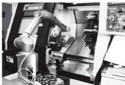
由于 UR 机器人具有自重小、体积小、安全性高及编程容易等特性，因此该机器人可以被自由地移动或被安装在生产设施的不同部位。其中 UR 机器人的一个独一无二的特性是在操作使用时无需安全围栏，因为当受到大于或等于 150 牛顿的外力时，机器人手臂就会自动停止运动。
