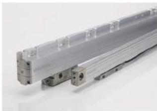
LC XX5的优势为：①支持新接口：EnDat 2.2（可达6 MHz）、新型Fanuc（ $\alpha i$ ）、Siemens（DRIVE-CLiQ）、Mitsubishi（高速接口，可达5 MHz）；②高分辨率：精度等级可达3  $\mu\text{m}$ ，最高为1 nm；③更优的细分精度：相比LC XX3版本，误差降低40%（LC XX5为 $\pm 100\text{ nm}$ ，LC XX3为 $\pm 200\text{ nm}$ ）；④安全功能：EnDat 2.2（纯串行接口）、DRIVE-CLiQ；机械连接具有故障排除设计（与LC XX3通用）；⑤优化密封结构：双层密封结构；⑥测量长度：LC 4X5至2040 mm，LC 1X5至4240 mm；⑦减少LC4X5读数头的厚度（安装尺寸与LC 4X3兼容）。
