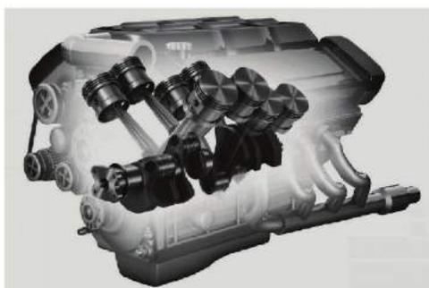
球墨铸铁是用于较低负荷发动机（主要是汽油发动机）的标准材料，而大马力发动机（包括大多数柴油发动机）则使用较昂贵的合金钢锻件。用于曲轴的钢种一般都会经过各种热处理，如淬
