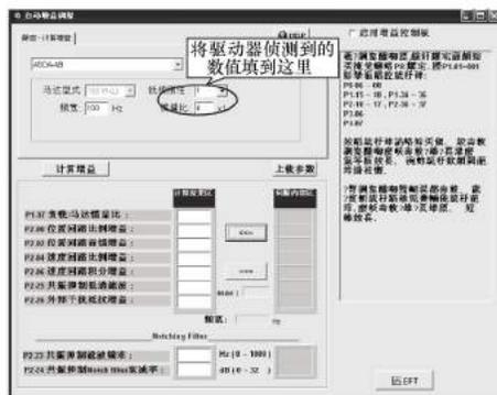
自动增益调整使用方便但不一定适用于所有场合，手动增益调整可根据不同情况单独调整个别参数。手动调整增益时，减小 P2-02 位置前馈增益可以降低机台换向时的振动，加大 P2-06 速度回路积分增益，可以改善摩擦力大的场合低速时的平稳度。
