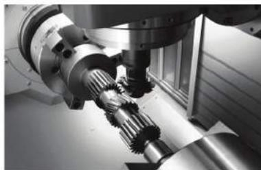
NT 和 NTX 系列多轴车铣加工中心的技术集成能够实现不同齿轮的中小批量生产
