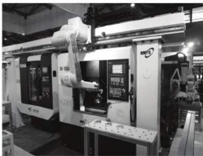
图1 大连机床集团盘类零件柔性生产线
