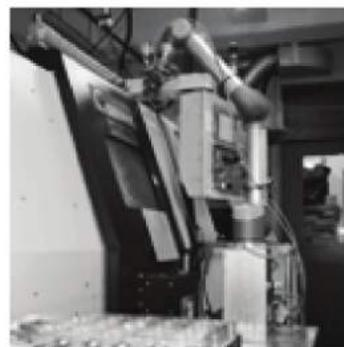
UR 机器人直观的图形用户界面（GUI）帮助用户仅需使用半个小时来安装与编程后即可投入使用。用户无需接受专业的编程训练，在为 UR 机器人编程时，可以通过直接握住并拖拽机器人手臂来示范其运动路径。
