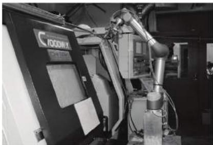
William Kuek 决定尝试将一台 UR 机器人与 Sky Engineering 的数控机床进行集成和测试。对此他解释道：“我们的生产线每周有 6 天都在 24 小时运行。寻找合适的熟练劳动力变得越来越困难，
