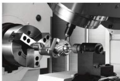
NT 和 NTX 系列车铣加工中心可在一台机床上完成从毛坯到齿轮的全套加工
