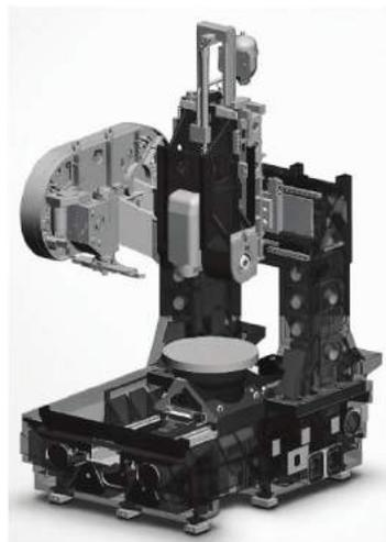
这两种机床通过其加工空间出色的接近性能给人留下深刻印象。在 HSC 70 linear 中, 这种接近性能通过下巴床身进一步改善。极小的安装面积也令人信服。紧凑型 HSC 30 linear 型机床仅需要  $4.5\text{m}^2$  的占地面积, 而且运动行程可达  $320\text{mm} \times 300\text{mm} \times 280\text{mm}$ 。加工区为  $650\text{mm} \times 600\text{mm} \times 380\text{mm}$  时, HSC 70 linear 的占地面积仅  $6.3\text{m}^2$ 。
