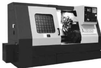
从而形成虚拟的Y轴进行。机床除具有高效、精密车削的基本功能外，还同时具有铣削、钻削、镗削、刚性攻丝的功能。
