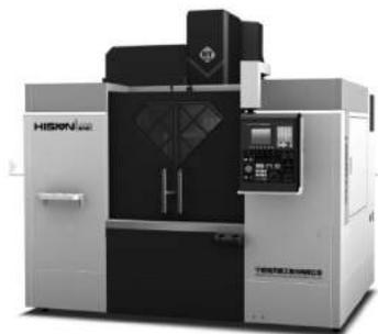
机床的典型应用如模具和板类、盘类、小型壳体类复杂零件的高速精密加工。
