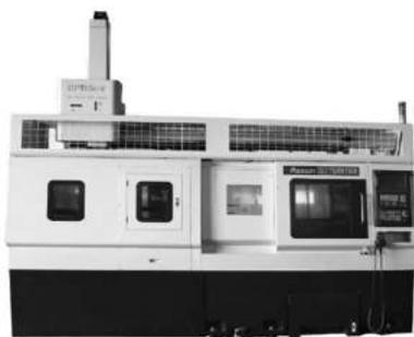
(3) 自动料仓根据客户需要灵活选择，最大可配置到 40 个工位；通用性强，操作简单，对人员技能要求低，工件直径以及长度发生变化后，只需要更换机械手以及机床卡爪，调用不同的加工程序直接启动机床即可完成。
