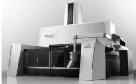
横梁在高架的墙体上高速运行,避免了大量的工作台和大型零件高速运动时对动态性能的影响,还避免了零件质量变化造成的动态性能变化。横梁驱动采用中心驱动原理,采用重心驱动原理,大大提高了机床动态响应性和精度稳定性。
