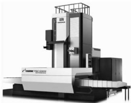
侧挂主轴箱布局，并配有刀具、工件冷却系统，工作台可在滑座上实现  $B$  坐标  $360^\circ$  的连续回转运动，通过碟簧夹紧，液压松开实现转台任意分度定位功能。其特点如下：
