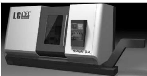
机床采用了卧式 55° 倾斜床身形式；上下刀架上下对称布置，具有结构紧凑、布局合理、排屑性能好、操作方便等优点；拉门移动轻松自如；便于配置工业机器人，为全自动和无人化生产提供了方便；电柜、液压站安装于机床背面。
