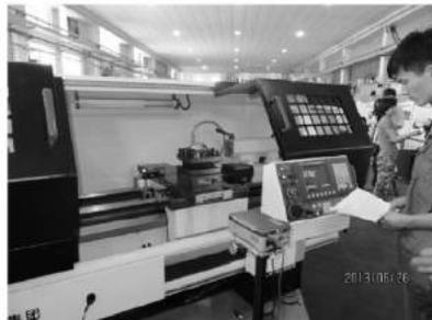
图10 大连机床生产的装有绝对式光栅尺的数控车床
