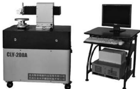
种平面、球面、非球面光学零件的素线形状、素线轮廓度等参数，具有测量精度极高，操作简单，测量范围广的特点，适用于光学加工行业中光学元件的测量。
