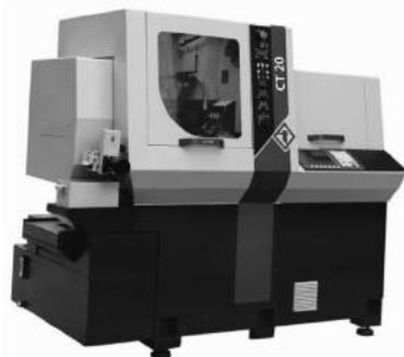
简单来讲，不同的模块化附件、5 轴机床、2 个完全独立的刀具系统，使得 CT20 - 5 并行加工成为现实。主轴功率高达 3.7kW、最多选配 10 把旋转刀具、最多可加装 26 把刀具、高精度加工，让 CT20 - 5 表现强劲有加。多项标准 CNC 功能、刀具取用方便，调整简单，又是其经济高效的源泉。
