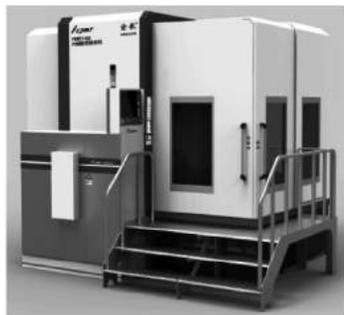
机床具有电子螺旋导轨、内外齿加工自动转换、辅助换刀、大行程自动调整、刀架自动提拉、斜向让刀、刀具自动上停等功能。
