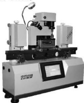
中图 SJ207 高度计，测量系统由测头、数显装置 SJ102 和陶瓷台架组成。系统测量精度高，量程范围 50mm。可广泛适用于产品计量、多点检测、测量设备监测和位置测量等众多领域，对长度、间距、厚度、高度或直线位移进行快速、准确的测量。
