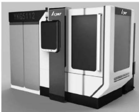
机床液压油、冷却油装备有自动油温调节装置，同时冷却油可在机床床身中循环流动，保证机床各位置温度的一致性，可有效控制机床热变形对插齿加工精度的影响。床身采用最佳切削处理结构，保证切屑顺利排出。
