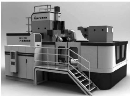
该机床适用于能源、交通、矿山、电力、重型机械等行业的大型高精度齿轮加工；可以加工各种直齿轮、斜齿轮、小锥度齿轮、鼓形齿轮、蜗轮等。
