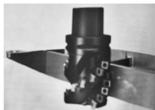
图1 角铣一个典型的钛制航天构件的 CoroMill 690 铣刀
