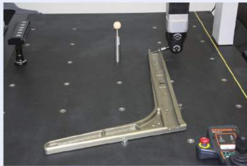
图4 坐标测量机记录每个已加工零件的实际误差：Renishaw 测头可以5坐标检测直升机座椅支架的形位误差
