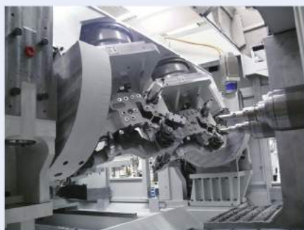
图1 双主轴LiFlex II 1078 / 2U加工中心适用于重型复杂工件的加工
