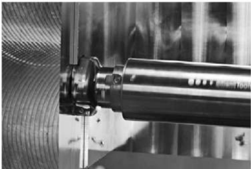
图 1 采用 Silent Tools 减振刀具实现更平稳的加工
