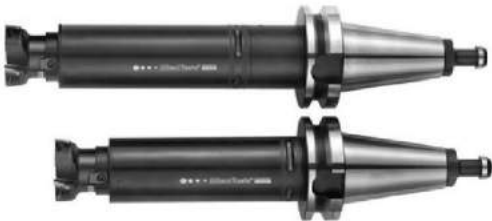
图 2 两种不同长度的减振接柄
