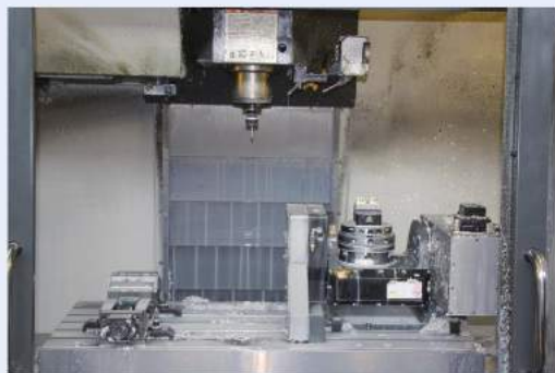
图3 3轴和5轴：2轴摆动回转台EFM可在哈斯机床上同时加工两个不同的工件
