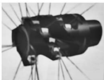
图2 在 CoroMill 690 铣刀内部通高压冷却剂
