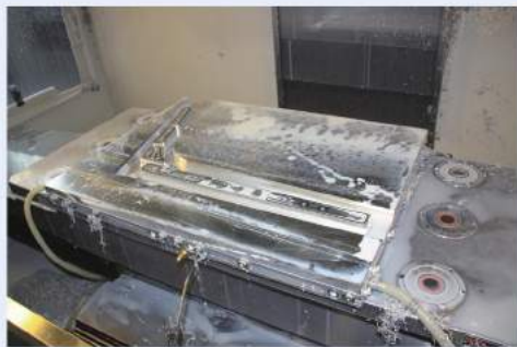
图2 生产率和重复精度高：利用零点夹持系统用真空夹具将工件固定在机床工作台上
