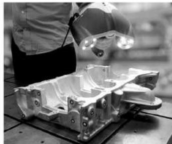
它适用于逆向工程/外观造型、设计和分析，如三维重建、外观造型与设计改造、已完成 CAD 修改、A 级曲面、车辆设计和外观造型、零配件部件设计、数字化模型与实物模型、粘土模型数字化、定制部件设计、包装设计、快速成型/3D 打印、有限元分析 (FEA)、非接触式检测、数模对比检测及几何公差 (GD&T) 等。
