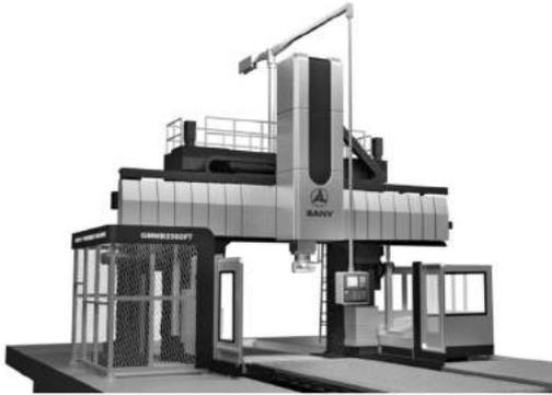
该机床可选用高速钢、硬质合金及陶瓷刀具, 完成高精度、高效率的铣、镗、钻、铰、刚性攻丝等多种加工, 适用于各种基础大件、板件、盘类件、壳体件、模具等多种零件的粗、精加工, 在汽车制造、模具、工程机械、航空、发电等领域均可发挥重要作用。
