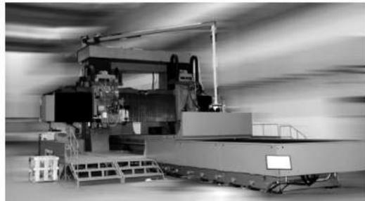
本机床主要用于机床制造厂对机床床身、工作台、立柱、拖板、滑鞍、横梁等类零件导轨副的大批量、多品种、多规格的精加工磨削; 能通过自动、手动 (电手轮) 对零件的主导轨平面进行周边磨削, 并能对其他平面进行磨削。本机床具有加工零件的纵向直线度凹、凸补偿功能。
