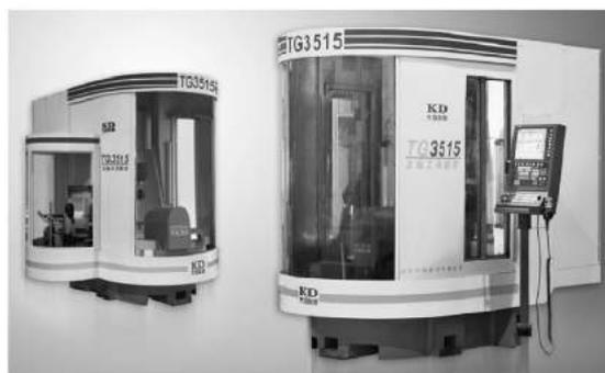
机床采用切削液集中冷却过滤系统, 过滤精度达到 1 $\mu$ m。此系统集成过滤、冷却、高压供油、油雾收集、排污清理等多个部件于一体, 各种配套器材性能优良, 提高了其使用寿命。
