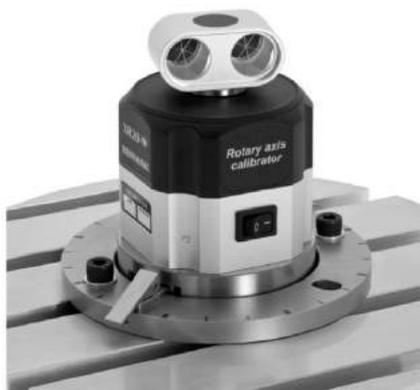
简单，由于避免了电缆拖曳问题，进而消除了安全隐患。XR20-W 的测量系统与安装系统分离，这种模块化方式使设定更加快速简单，而且可以针对各种不同的转台、车铣复合等其他回转轴进行测试。小巧轻便，一只手即可握住并装卡到机床上，运输方便、节约成本。极大降低了在机床上安装时的偏心要求及操作空间要求。
