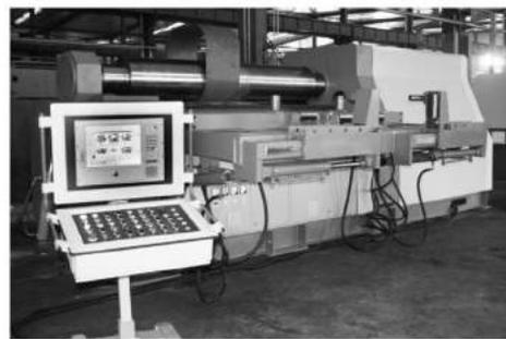
上辊固定，下辊和两侧辊可以通过油缸控制上下移动。四辊均为主驱动辊，由液压马达和行星减速机驱动，通过其旋转为板材卷制提供扭矩；具有锥筒卷制功能。为了方便锥筒卷制，该设备上辊和两侧辊采用调心滚子轴承，可倾斜调整。
