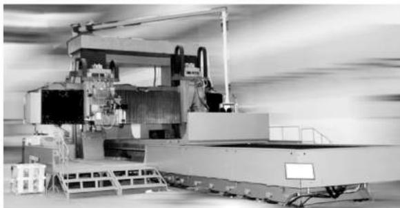
本机床具有加工零件的纵向直线度凹、凸补偿功能。
