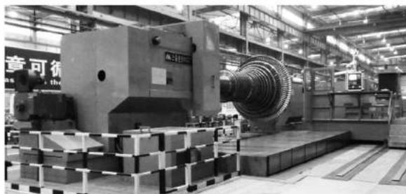
机床主轴由 SIEMENS 主轴电机驱动, 其连续运转的功率为 100kW, 最大功率为 147kW。配 SI-
