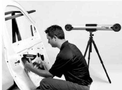
适用于检测和逆向工程：如数模对比分析；初样检测；供应商质量检测；针对 3D 模型与原始部件/生产工装的一致性评估；制成部件与原始部件的一致性评估；对齐；工装检测。
