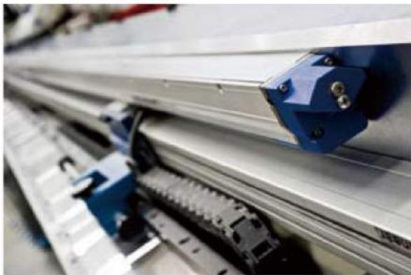
图1 基于高质量光学技术的Fagor位置测量系统：轴向行程达到40m的产品即将推出
