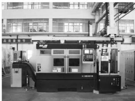
机床采用双主轴、双刀架对称布局；分离式床身，减少加工过程中两主轴之间的相互影响，提高了加工精度和刀具寿命；液体静压和滚动导轨，提高了机床的耐用性和加工精度；集中式机床操作板，使机床操作简便、快捷；带自动上下料系统和零件翻转机构，可用于零件两端面连续加工，也可两轴加工同一零件。
