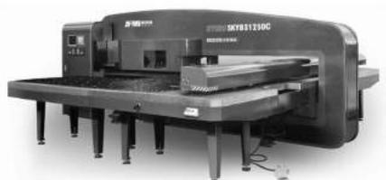
该机加工板材尺寸  $1250\text{mm} \times 2500\text{mm}$ ，加工板材厚度  $6.35\text{mm}$ ，冲孔次数  $1000\text{次}/\text{min}$ ，加工精度  $0.1\text{mm}$ ，4 轴控制。德国哈雷公司原装进口总成液压系统，数控系统为日本 FANUC，精密滚珠丝杠和直线导轨选用德国 REXROTH 或日本 NSK。
