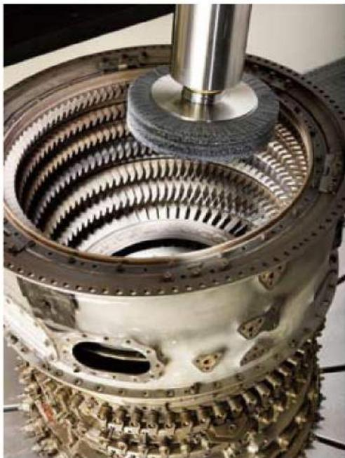
图1 定子机壳，只需一次装夹便可完成磨、车、去毛刺和测量
