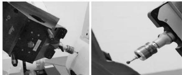
图 20 基于 Leica T-MAC 接触式自动测量系统
