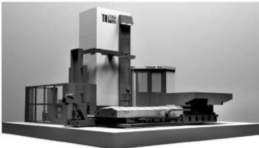
本产品属高精、高速类，X、W 轴向进给轨采用进口直线滚柱导轨副，丝杆支撑轴承采用进口精密轴承，组成高可靠性的驱动系统，运动平稳，动态及静态精度高。自动连续回转（B 轴）可任意分度，回转台采用带集成角度测量系统的转台轴承支撑，其动、静态性能俱佳，同时实现闭环控制，保持准确的定位，驱动平稳，定位精度高。
