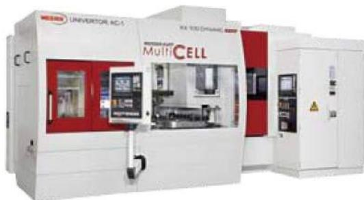
图2 Weisser-Kapp MultiCell高技术系统, Weisser回转车削方法与Kapp齿轮轮廓铣削复合, 可用于淬硬齿轮的精加工
