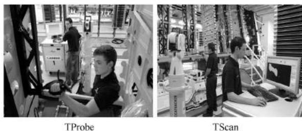
图4 使用 Leica 激光跟踪仪结合手持无线测头、手持激光扫描系统检测飞机产品和型架
