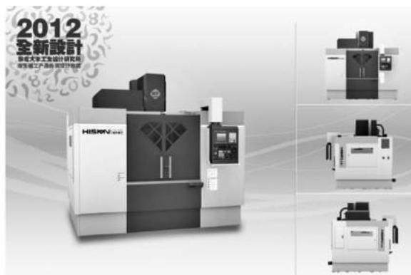
该加工中心结构紧凑、占地面积小, 有较好的刚性和抗振性。能在一次装卡下完成铣削、镗削、钻削、攻丝等工序。标准配置选用 12 000r/min 陶瓷球轴承主轴, 更适合模具加工。同时, 选配零件加工主轴 (8000r/min) 时, 也适用于通用机械、汽车、航空航天、仪表、纺织机械等行业中小型机械零件的高速精密加工。若选配数控转台, 则将机床原有的三轴三联动扩展四轴三(四)联动, 并实现多面加工。
