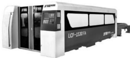
激光发生器为日本 FANUC 原装进口，加工板材尺寸 1500mm × 3000mm，加工厚度 30mm 以下碳钢，不锈钢 12mm 以下。机床最高定位速度可达 140m/min，最高切割速度可达 15m/min。5 轴/6 轴控制，日本 FANUC 数控系统和激光器的完美匹配，发挥其最优性能和开放性。
