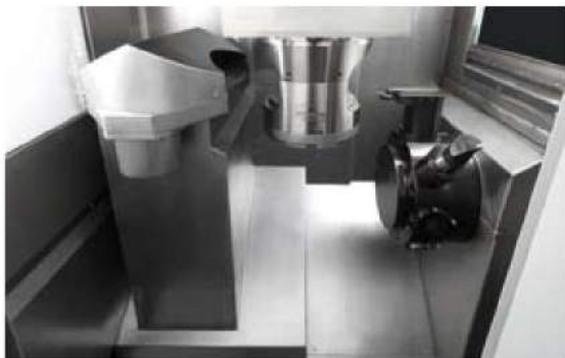
图1 AM工作区：机械手将坯件装入Stermann系统，然后把工件送入加工区，随后进行全部加工
