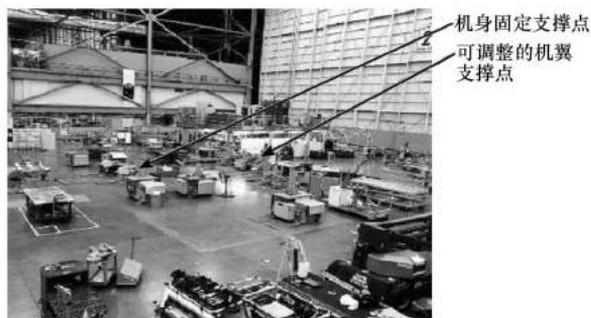
图12 机翼与机身对合工装
