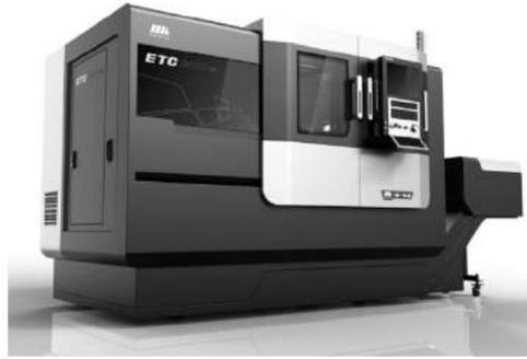
该机床 Z/X 轴定位精度为 0.014/0.011 (mm)，Z/X 轴重复定位精度为 0.006/0.005 (mm)，加工精度 IT6，表面粗糙度可达 Ra1.6μm。
