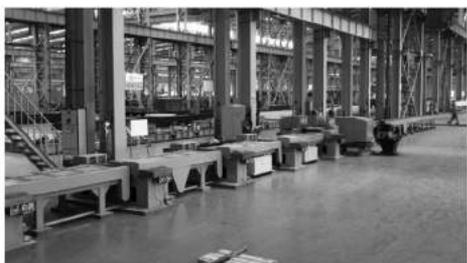
本设备设计了多单元组合结构，在保证强力刚性的同时，充分利用结构空间，合理布局，主轴与压辊轮两箱体，由4块滑板组合的单元，根据维护需要，随时可自动分离与闭合，工作时两箱体合二为一，稳固紧凑，为快速更换刀具创造了充分空间。
