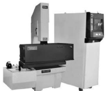
(3) 硬质合金及石墨等专用加工电源回路，主轴高速抬刀，高速伺服功能，适用于大深径比窄槽窄缝加工。
