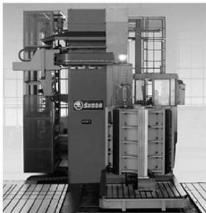
SKODA 公司制造的 HCW 的数控落地式镗铣床和 HCW-series 钻孔机床是更先进、更复杂的高水平差异化机床。这些机床具有大功率和稳定的加工精度,特别适合高精度大型和异形工件的铣、钻、镗工序的加工。这些特性化机床可以高效加工发电机转子轴、大型舰船曲轴、船用螺旋推进器和其他大型复杂异形工件。
