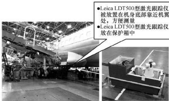
图13 Leica 激光跟踪仪在机翼机身对合工装中位置
