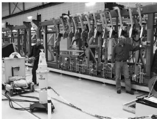
图 3 Leica LTD500 型跟踪仪辅助测量装配型架
