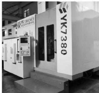
的齿轮及工艺参数后，软件可自动生成机床运行 G 代码，实现真正的零编程。
