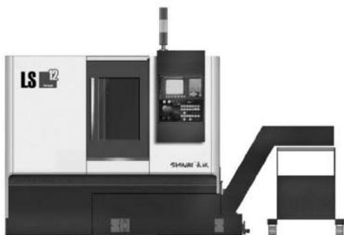
本机床采用了卧式床身，45°倾斜导轨结构，具有排屑性能好、操作方便、布局合理等优点，便于和工业机器人配合，为全自动和无人化生产提供了方便。机床防护采用全封闭式框架结构，拉门移动轻松自如，并且电柜、液压站安装于机床背面。
