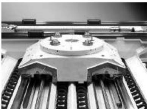
图3 安装在 NBH 1000 上的新兴 转台配直接驱动（扭矩电机）
