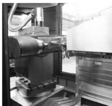
图 20 TX6/1000HV 专用磨床加工工位外观
