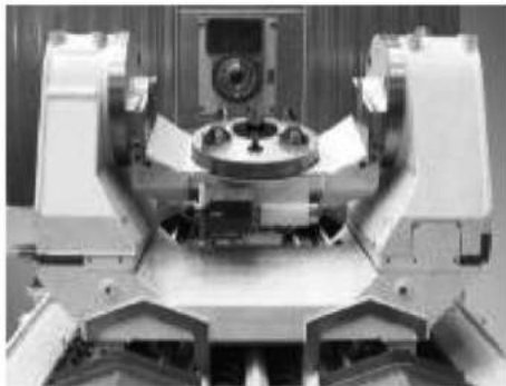
图5 所有 NBH 主轴均可毫无限制的与任意摆动/旋转工作台进行组合
