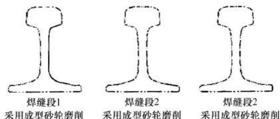
图5 XFGT001 型数控钢轨轨腰焊缝磨床加工工艺
