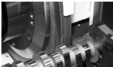
图3 陶瓷 CBN 砂轮的凸轮轴磨削
