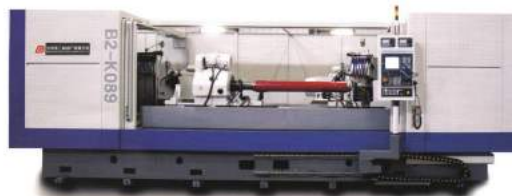
图1 B2-K089型双砂轮架数控车轴磨床外观
