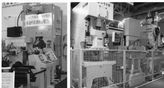
徐锻高速精密压力机生产线 扬锻高速精密压力机生产线
