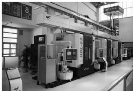
图1 大连机床集团展出的EA型缸体加工柔性线
