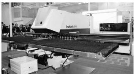
通快冲-焊-激光复合加工机
