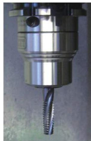
图2 非涂层整体硬质合金铣刀产生短切屑，避免了车削时难以避免的刀瘤等问题
