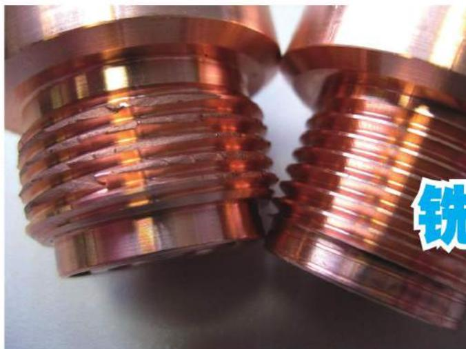
图1 车削由软铜合金制作的喷嘴 螺纹经常产生废品，因为刀瘤产生喷溅（左）。相反，现在铣螺纹时，螺纹顶部、侧面和表面都很完美
