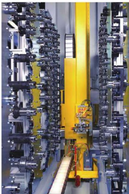
图2 为 Peiseler配备了可安装240把长1000mm，重60kg刀具的刀库和机床结构图示
