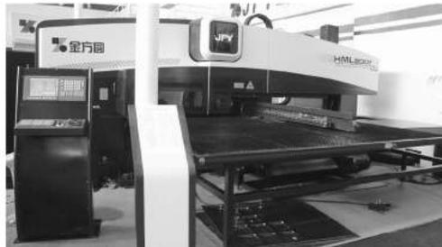
金方圆冲-激光复合加工机
