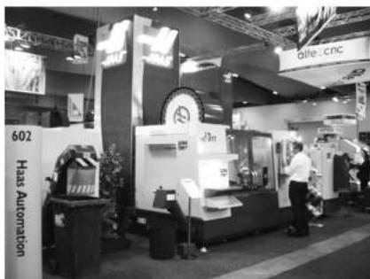
此外，HAAS 公司还展出 ST30 数控车床和 ST20SSY 具有 4 轴联动的车削中心。该系列机床托板和尾架体均采用平导轨，Y 轴采用虚拟轴，双主轴对置，机床配置对刀仪、工件输料器和工件收集装置。
