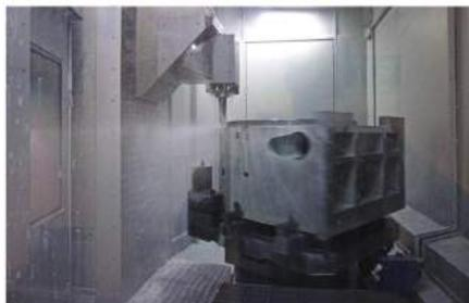
图3 一个可转位刀夹壳体在镗孔
