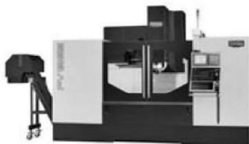
WELE 代理销售公司展出了丰田工机 (TOYODA) 制造的 AA1365 series 立式加工中心。机床 Y 向采用双驱动并且配置了 4 副导轨，外侧主导轨是宽幅滑动导轨，内侧两辅助导轨采用直线导轨，外侧主导轨宽度是十字滑台长度的 0.56 倍，使工作台 X 向全行程始终处于重心稳定区域。该机床特别展示的和滚珠丝杠轴向接触的支撑端面，全部采用人工刮研工艺。该机也采用多冷却喷嘴冷却刀具和工件。
