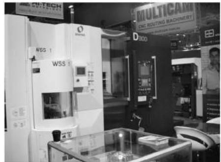
此外，展出的 D300 五轴联动立式加工中心，实际上是一台 FMC 加工单元。主轴转速 1500r/min，可配置 3000r/min 主轴。采用 A/C 轴回转摇篮式工作台。在机床前部配置了呈 C 型分布的 4 位 3 层的工件存储库，在储存库可交换工作台上安装了 12 种不同类型的复杂工件；由可实现 3 个方向移动的垛料机进行工作台的交换；刀库配置 40 把刀具，机床进给速度直线轴 60m/min，A 轴回转速度 45000°/min，C 轴回转速度 54000°/min。
