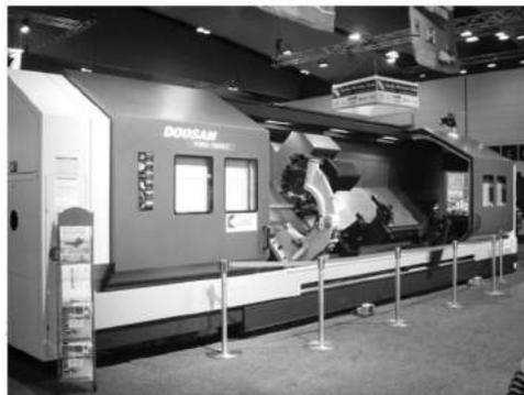
加工。该机采用大宽幅矩形导轨及通过变速箱 3 级变速使主轴获得  $6605\text{N}\cdot\text{m}$  大扭矩，可满足大径工件的大扭矩重力切削；该机加工最大长度 3.2m，配置定直径中心架和自动编程可变径中心架。
