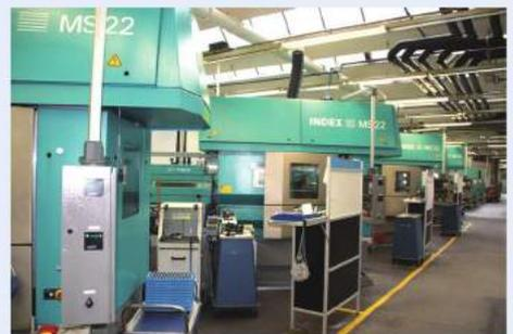
为节省场地、提高生产效率而倾斜安装的Index MS22型6轴车床
