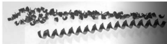
使用普通加压冷却液输送系统产生的长切屑与 使用山高 Jetstream Tooling 飞流高压直喷系统 产生可控的短切屑
