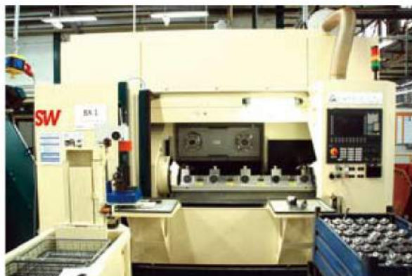
图5 BX 621机床上面和前面敞开的工作空间可借助于机器人或门式机械手,灵活地实现自动化生产
