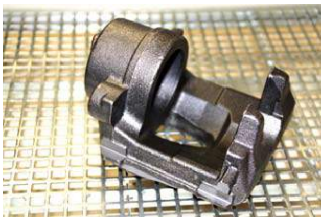
图1 材料为 GGG 50的尚未加工的制动座毛坯，大陆公司在BA 600 型 SW 双主轴双工位机床上进行大批量加工和在新的BX621型双主轴单工位机床上进行小批量生产
