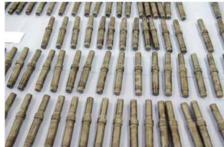
图2 外圆磨削到要求的尺寸、精度和表面质量
