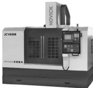
科学合理的结构设计，使机床具有高稳定性、高刚性和高精度。主轴轴承采用进口名牌高精度滚动轴承，从而保证了主轴的回转精度和刚性，适合重负荷切削。
