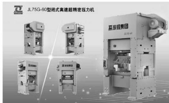
(1) 多连杆驱动机构，下死点区域加速度显著降低，有效抑制速度变化对下死点的影响，从而实现高效、高精冲压。
