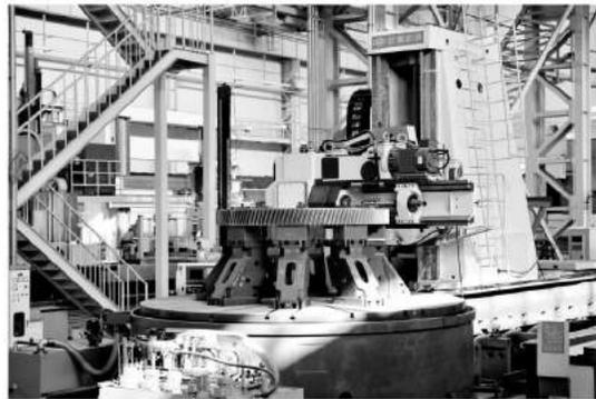
机床自动化程度高，功能完备，适用于矿山、风电、船舶、军工等行业齿轮制造，能够实现多种方框循环加工，并能顺、逆滚齿，可广泛用于滚切圆柱直齿轮、斜齿轮、鼓型齿轮等齿轮加工，也可加工蜗轮。
