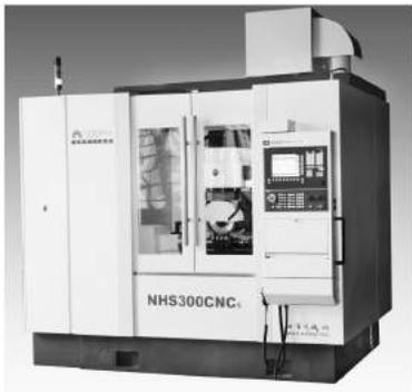
床身采用高强度灰铸铁铸造而成，经过多次时效处理消除内部应力，增加了机床稳定性，减少机床振动，从而使得刀具刃磨精度得到良好的保证。
