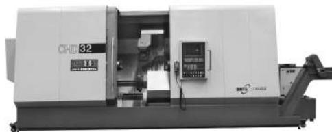
CHD-32 九轴五联动车铣复合中心机床为整体倾斜床身布局,机床可以配置有双主轴和上、下双刀架,上刀架带Y轴、B轴、带刀库,可实现五轴联动加工,机床最大快移速度为80m/min,车削主轴最高转速5000r/min,铣削主轴最高转速7000r/min。
