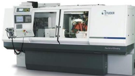
图1 全配置S40万能外圆磨床与StuderGrind CAM系统联网，利用三轴转塔：C轴和B轴及集成的修整盖实现完全加工
