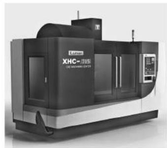
该产品为 X、Y、Z 三轴伺服直联控制半闭环立式加工中心, 主轴为伺服电机动力驱动, 刀库容量 16 或 20 把可选。X、Y、Z 向导轨均为加宽矩形滑动导轨, Y 向四导轨支撑, 并经中频淬火及精密磨削; 滑动导轨面贴覆复合 PTFE 材料并精密刮研, 配合自动强制润滑。机床采用采用高速、高精度、高刚性主轴单元, 轴向和径向承载能力强, 转速最高达 6000r/min; 实际转速 80~3500r/min, 适用于低速重切削。
