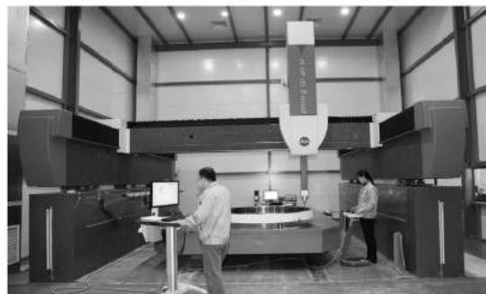
在该公司众多性能优良的制造装备当中，来自海克斯康的超高精度、超大型坐标测量机 Leitz-PMM-G 504012 尤其引人注目。该设备行程范围可达到 5000mm × 4000mm × 1200mm，而测量精度可高达 2.8μm，提供了稳定可靠的性能、超高的精度、高效的测量与扫描速度；配备业界知名的 QUINDOS 测量软件，能够完成各种圆柱齿轮、伞齿轮、蜗轮蜗杆及齿轮刀具的测量，可完成直径达到 4m 的齿轮检测。同时，该方案还具有极大的通用性，能够用于各种零部件类型的精密检测和质量评价。
