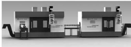
该机床主要用于汽车刹车盘、刹车鼓加工行业使用的生产线。该生产线具有高精度、高效率、高可靠性和高柔性自动化加工的特点,能够实现刹车盘自动装卡,完成粗车、精车、铣削、钻孔、攻丝、镗孔、双面车、双面磨,采取了多项物流机构上工件位置的可靠性检测手段,实现了工件从
