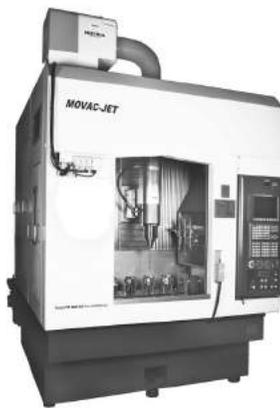
该系列清洗中心的高压主轴是丰禾自主研发制造，结构简单，加速速度快，并且在日本和中国都取得了发明专利。该设备采用变频科技技术，工业水循环使用，最大限度避免了因燃烧、爆炸以及电化学产生的有害物质对环境的破坏，在创造高效率的同时，做到了节能减排。
