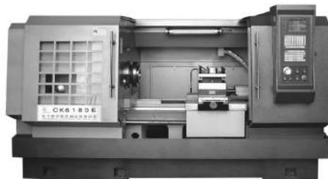
进给系统采用伺服电机、精密滚珠丝杠、高刚性精密复合轴承结构，定位准确、传动效率高。
