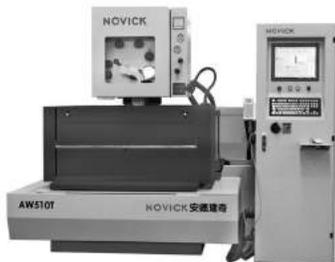
机床采用全功能 CNC 控制系统：5 页彩页显示画面分别用于准备、加工、编辑、图形检查及维护，操作简单。拐角控制功能有效地抑制了电极丝的滞后带来的形状误差。运丝系统使丝的张力恒定，保证整个运丝系统始终处于动态平衡状态。运丝系统可在 20 档范围内任意设定。自动穿丝系统省时省力，操作便捷。
