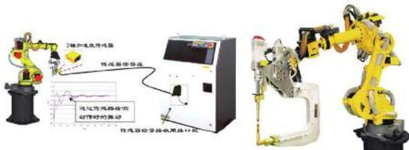
学习机器人通过加速传感器检测振动，参照反复学习得到的数据来抑制振动，缩短动作周期约20%。学习过程中，加速传感器可优化机器人动作且动作轨迹保持不变。学习结束后，即使不使用加速传感器依然能实现高速动作。
