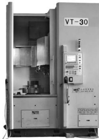
机床采用半闭环控制方式；整体底座，宽立柱结构，其主要基础件均采用树脂砂铸造，人工时效处理，整机稳定性好；纵、横向驱动采用宽导轨结构，导轨副采用高频淬火（硬轨）加“贴塑”工艺，动态响应特性好，精度高，寿命长。
