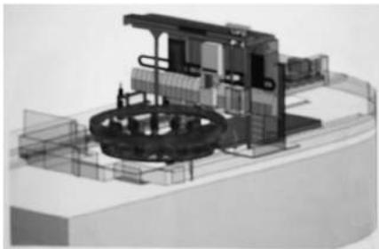
图 2 瓦德里希·科宝公司的可加工直径 12m 齿圈的机床示意图
