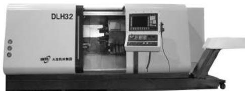
DLH-32 机床采用 45°整体斜床身结构；机床 X 轴导轨采用直线导轨，驱动装置采用高速静音化滚珠丝杠副驱动，瞬间可以承受较高的加速度；机床 Z 轴导轨采用高刚性直线导轨，驱动装置采用直线电机直接驱动，直线电机初级和次级均采用冷却水冷却，减小热变形对机床几何精度的影响；Z 轴测量反馈装置采用高精度绝对值光栅尺，实现闭环控制；主轴传动系统采用内置电主轴驱动，主轴内置电机配置循环水冷却装置；主轴前端轴承采用 4 列超高速陶瓷球轴承，减小高速运转时离心力对轴承寿命的影响。
