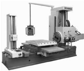
机床的主运动及各坐标移动均采用伺服电机拖动,可实现转速及进给速度无级调速。
