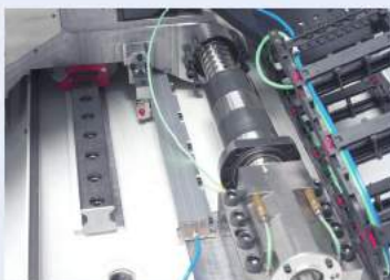
图2 Y向拖板两侧配置有滚动导轨、线性测量系统及再循环滚珠丝杠，提高了动态性能和精度
