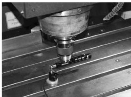
图 16 补偿前后对照比较实验的球杆仪测量
