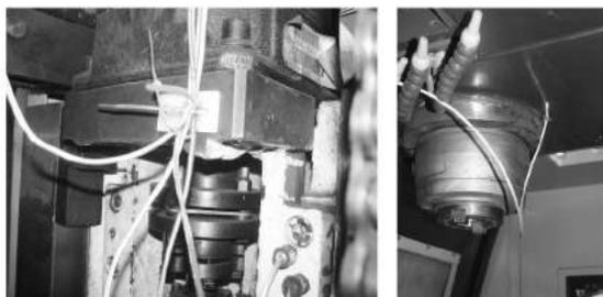
(a) 主轴上端温度布点 (b) 主轴下端温度布点
