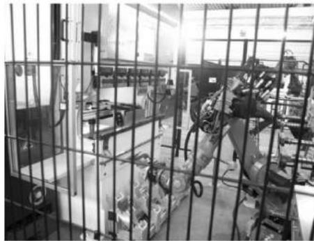
钣金加工机器人柔性制造单元
