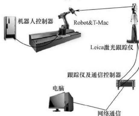
图 5 系统的连接及通信示意图
