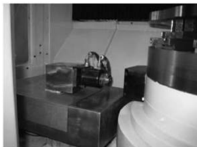
图3 MGKF600/4 立式复合磨床偏心量的调整
