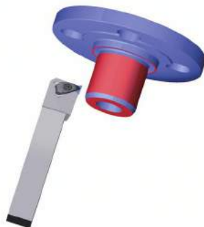
图4 在提高切削速度的情况下对硬度为58~62HRC的轮毂进行纵向和端面车削。
