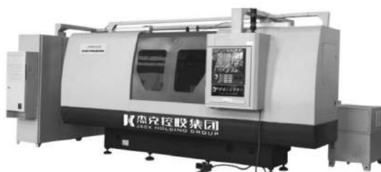
图 12 JKM8320B 超高速 CBN 随动数控高精凸轮轴磨床
