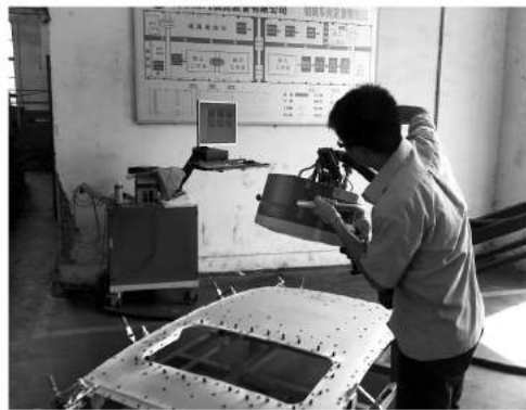
图1 Cognitens 拍照检测系统实现可移动式现场测量
