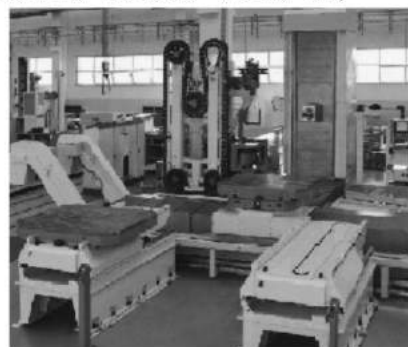
图8 大型双交换工作站卧式加工中心
