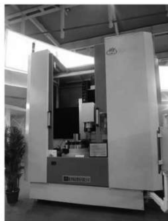
图2 MGKF600/4立式复合磨床
