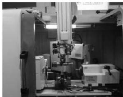
图2 桁架机械手自动装卸工件
