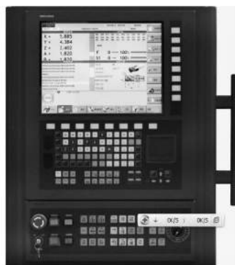
图5 GNC60 光纤总线开放式高档数控系统
