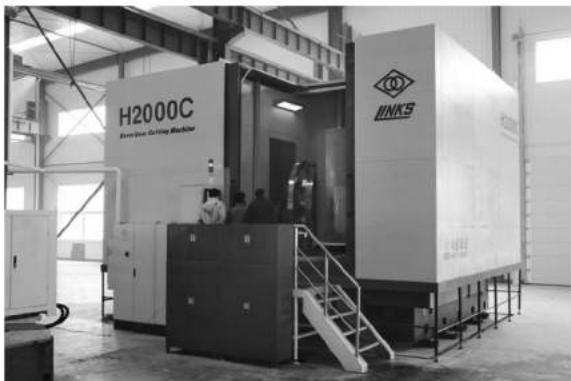
图2 加工 2000mm 的数控弧齿锥齿轮铣齿机、磨齿机
