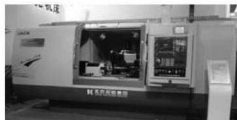
图9 JKM8320B 型超高速 CBN 随动数控磨床外
