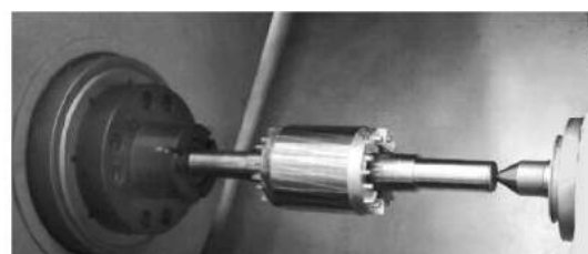
图 6 电机轴切削装卡示意图
