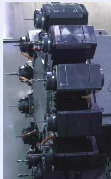
图1 三叶形深孔钻和整体硬质合金阶梯钻优化了自动车床上的系列化生产
