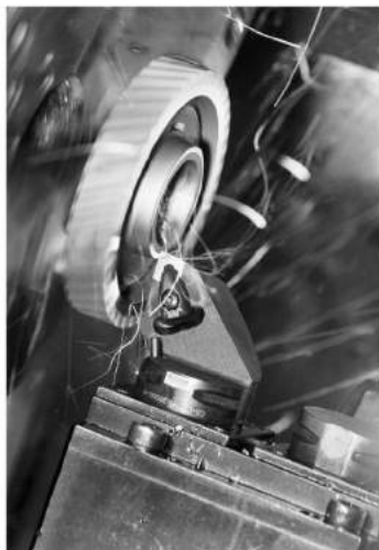
图1 零件硬车削是淬硬零件（硬度范围通常在 55~65HRC 之内）磨削的替代选择，两种加工方法可互为补充。现代 CBN 材质意味着可提供更多坚固耐用的刀具，目前的刀片技术也促成了生产效率和精加工能力均大幅提升的切削刃
