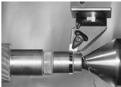
图3 Xcel 刀片是一种独特的、已获专利的刀片概念，特别适合于高效率的硬零件车削，当对表面光洁度和安全性要求较高，并且需要进行具有高材料去除率的粗加工时，XCEL 就非常合适
