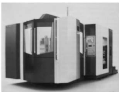
图1 DMC/森精机的全线性驱动、刀库独特和系统组合 部件模块式的新卧式加工中心 DMC 60 H linear 外观
