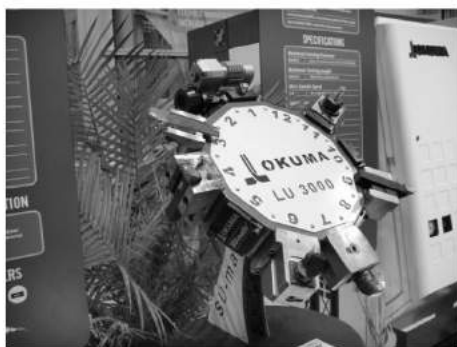
图8 采用直驱技术的动力刀架
