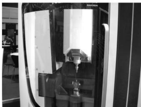
图9 DMG 公司 Ultrasonic 20 linear 各直线轴均采用直线电机
