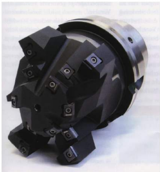
图3 在涡轮增压器壳体加工中，切向组合刀具一次完成6项加工
