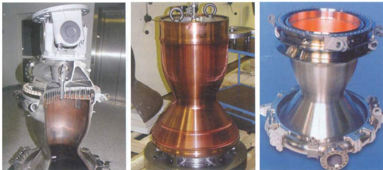
图 1 在欧洲宇航技术研发中心（EADS Astrium）用最现代化的切削技术制造的阿丽亚娜 5 的发动机部件： 主发动机（左），铣削好的冷却管道（中）和燃烧室（右）
