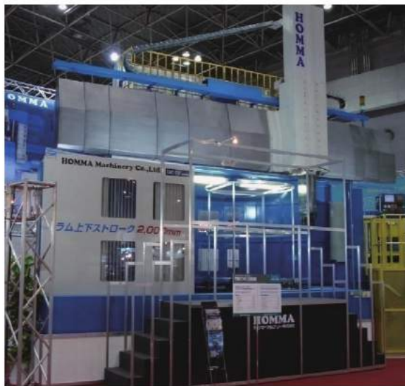
图8 本间公司（HOMMA）展出的双柱立式车铣复合机床
