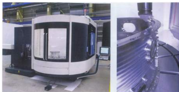
图 2 DMC 125 FD duoBlock 通用型铣-车中心,不仅能五轴铣削,还能在同一次装卡中进行精密车削(右图)
