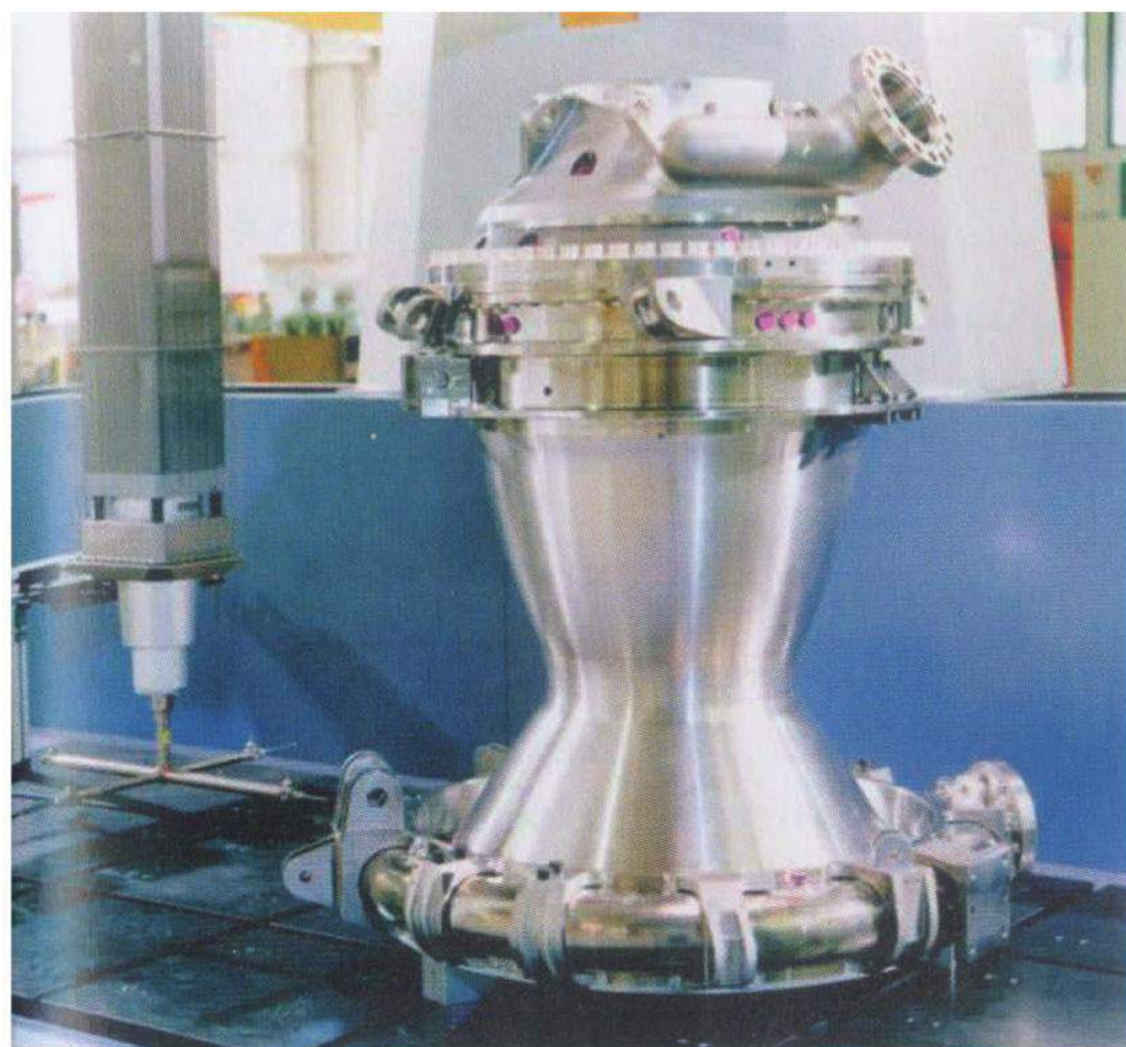
图 3 由 DMG 公司的加工中心加工的零件组装成的完整的发动机燃烧室
