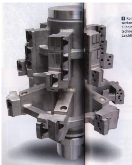
图1 带有导向块技术的轻量化组合刀具
