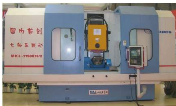
图3 七轴五联动数控的 MKL7150×16/2 型强力成形磨
