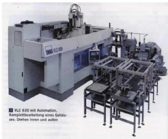
图1 VLC 630 自动化机床，可完成壳体件的全部加工：内圆和外圆车削
