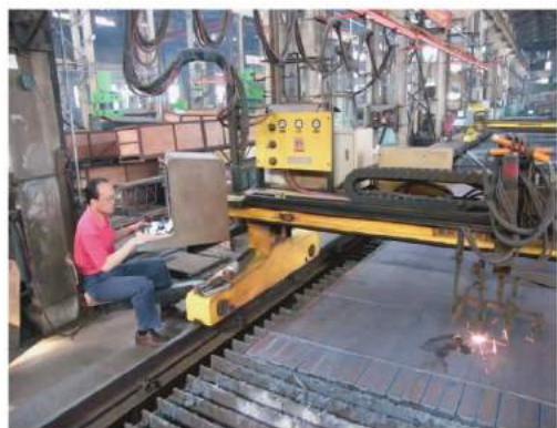
图1 用数控切割设备下料
