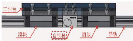
带自锁功能的滚动直线导轨副
