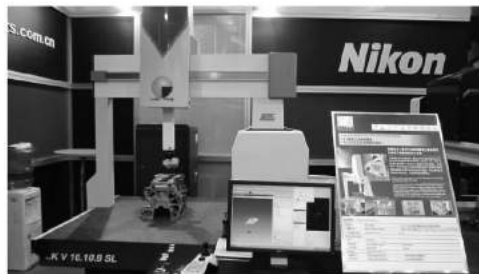
图2 日本尼康公司采用十字交叉非接触扫描专利技术的LK V 10.10.8SL坐标测量机
