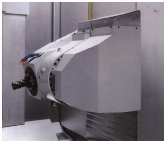
图4 STC系列的特点：稳定的单轴回转头
