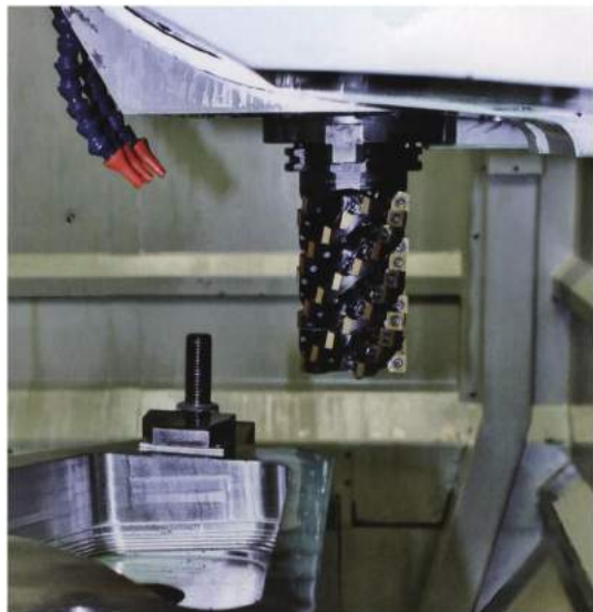
图5 STC100型加工中心正在粗加工钛合金结构件。这种机床稳定性好，具有良好的减振性能，主要用于从整体材料上直接铣出深腔体，使用经济、精度高
