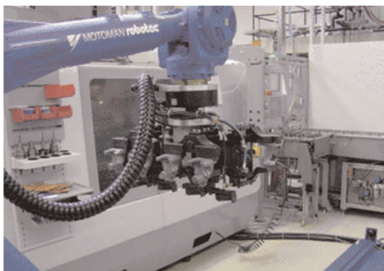
图4 自动排序：6轴Motoman机器人从进料皮带上取下四个压缩机缸体（工件）并以预定精度液压夹紧在四工位夹具上
