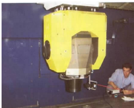
图1 JOBS S.P.A. 公司在五轴高速加工中心上使用光动公司专利许可的激光空间测量技术
