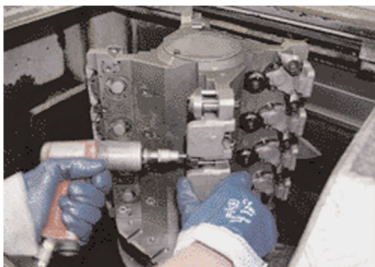
图3 尺寸波动和变形少：利用16工位夹紧块体上的压缩气钳固定工件的夹持方法
