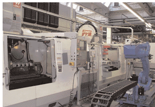
图6 Haas生产单元: 传送机器人安装在活动导轨上,除了能为图2所示的二台机床服务外,还可为镜像安装于右侧的机床服务
