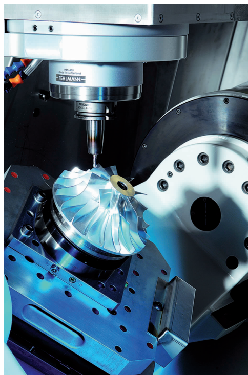
图2 为加工复杂零件而设计的Picomax 825 Versa 加工中心,图中所示为叶轮的铣削加工
