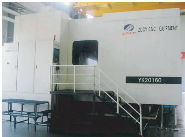
图1 YK20160全数控螺旋锥齿轮机
