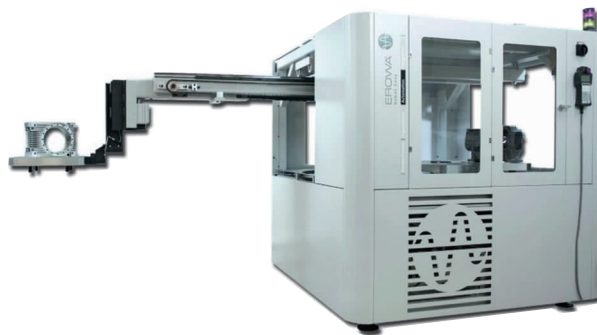
图4 机器人传送装置,可将重250kg的零件 传送1500mm
