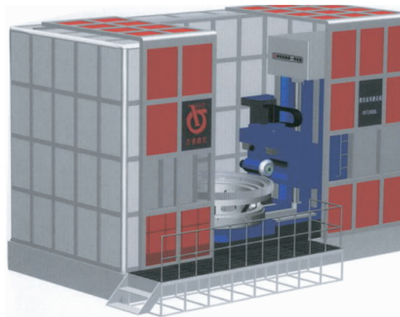
图2 YK73400L数控成形磨齿机
