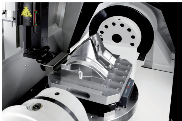
图3 Picomax 825 Versa机床的圆形转台， 回转达范围： \pm 115^\circ
