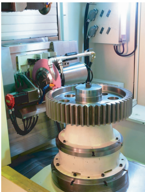
图7 LFG-8040齿轮成形磨床
