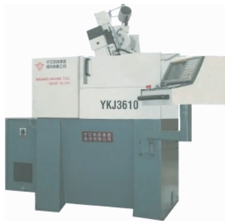
图6 YKJ3610数控高效卧式滚齿机
