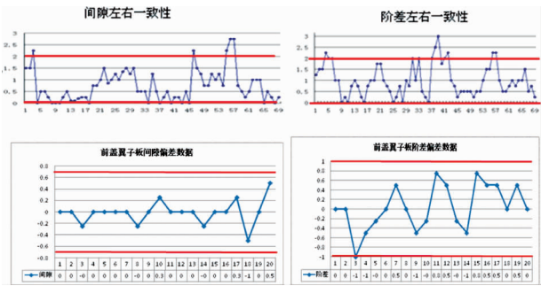
图7 某车型前盖与翼子板间隙阶差生产偏差数据
