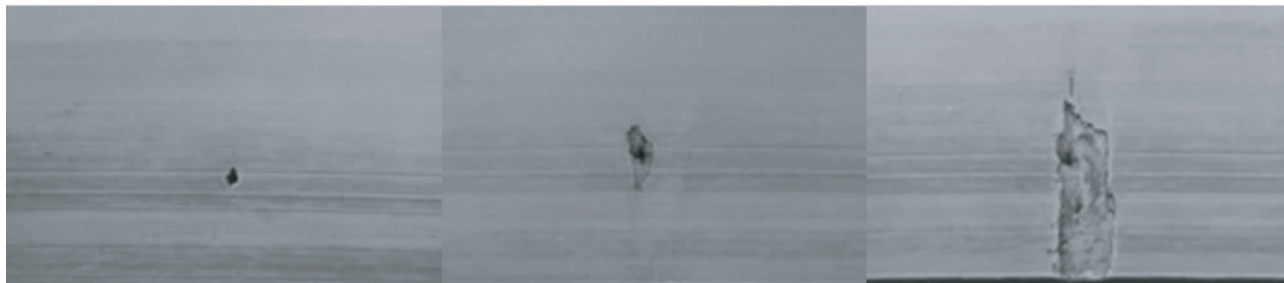
图1 轴承表面剥落发展
