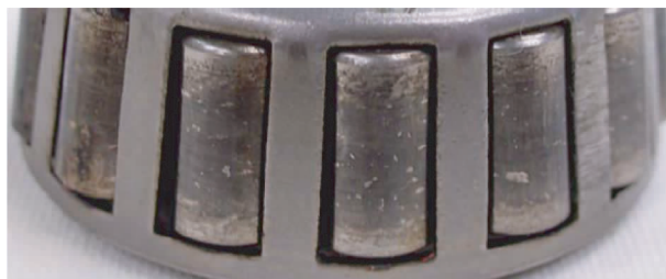
图3 在润滑不良的情况下运转，轴承有可能会发生损伤
