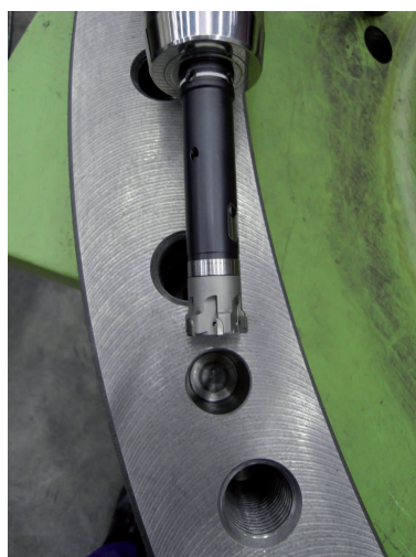
图2 利用新型Dihart DAH零点中对刀夹,即使是在不太理想的机床或主轴状态下也能保证最佳的同心度
