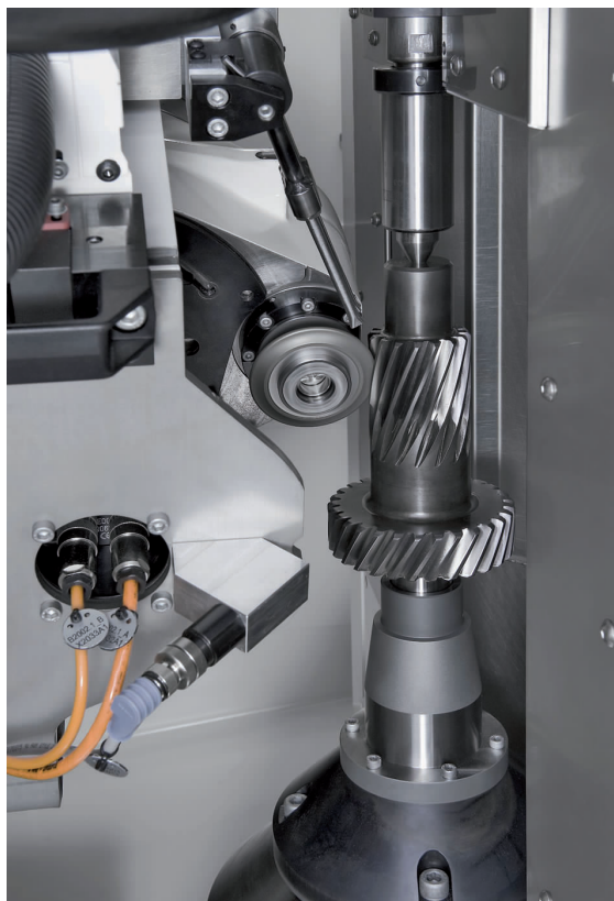
图3 采用 Reishauer 轮廓磨头磨削齿轮轮廓时，跳动很小，如在生产实践中证明确实需要时，可以加装 C4 轴
