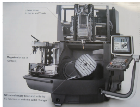
DMG公司DMU60evo型立式5轴复合机床, 多轴直驱
