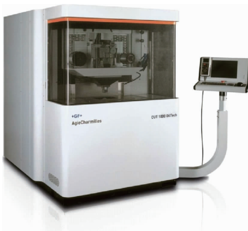
阿奇夏米尔公司CUT1000型精密电火花机床
