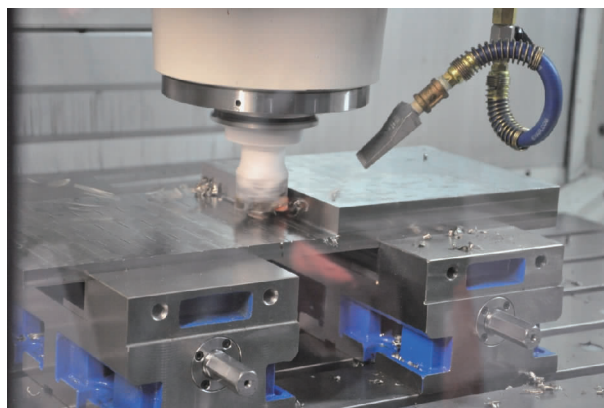
MAG公司液氮冷却刀具系统
