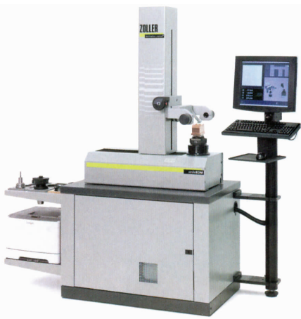
图 11 既适于刀具也适于电极预调和检测的 smile EDM 预调仪
