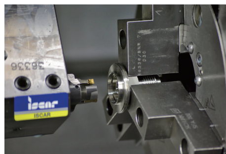
图4 由于刀具极为稳定，利用规定的空心钻头能精确加工出不同宽度的槽，从而提高了生产效率
