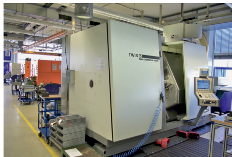
图3 材料为 1.4571 的固定座全部是在 Gildemeister ‘Twin 65’ 车床上加工的。
