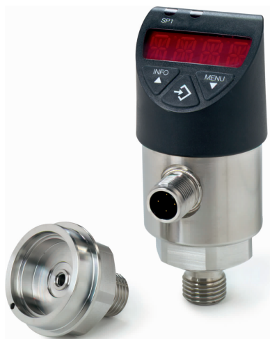
图1 安装电子压力测量元件用的螺纹适配器带有内轴向槽，图示为装有 PSD30 压力开关的部件。
