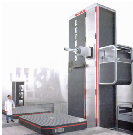
图 4 加工大型零件的高精度、大功率的“Invar”镗铣床
