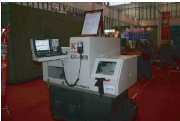
图 21 KDC-20FH 五轴四联动小型高速车铣复合加工中心
