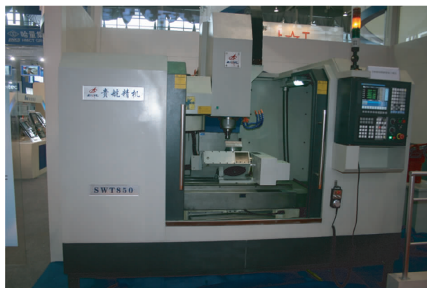
图4 配置华中 HNC-08 数控系统的五轴联动加工中心演示倾斜面加工
