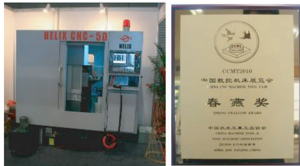
图 20 配置华中系统的 HELIX-CNC-5D 五轴联动数控工具磨床及其获得的春燕奖
