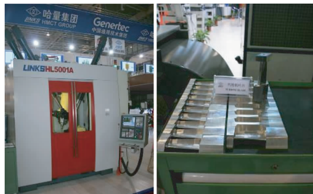
图 19 配套华中数控系统的哈量集团 HL5001A 并联加工中心及其加工的叶片
