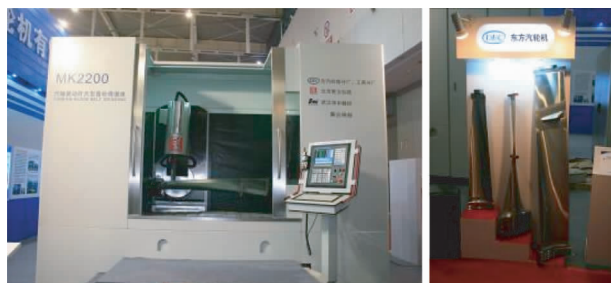
图 18 配置华中系统的 MK2200 九轴六联动数控砂带磨床及其加工的叶片
