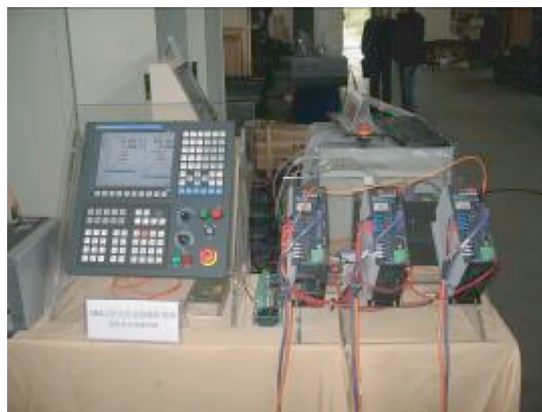
图1 华中数控展出的 HNC-32e 光纤总线系统
