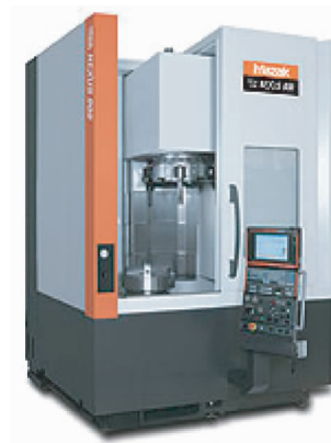
图 2 耐磨损设计：Megaturn Nexus 900 重量达 14t，具有极高的稳定性和刚性，所有运动轴均采用滚动导轨，最高运动速度可达 24m/min
