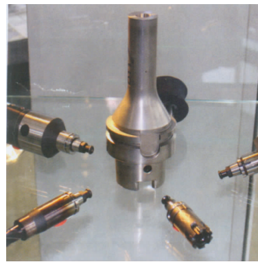
图4 HKS刀套的各种只换刀片的HFS刀头
