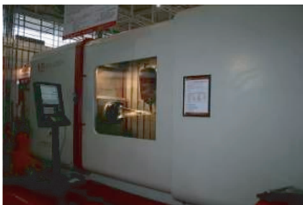
图 22 KDC-4200FH 14 轴五联动卧式车铣复合加工中心
