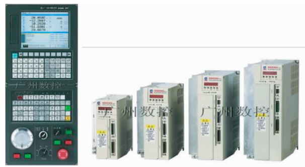
图6 GSK 980MDa 钻铣床数控系统 与GS系列通用伺服单元
