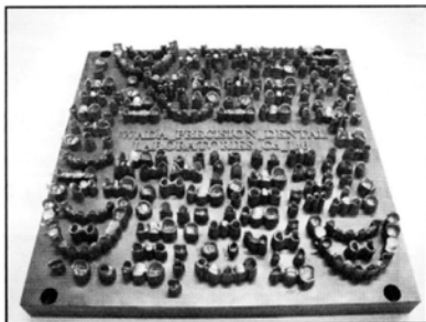
图4 增材制造技术加工出的假牙牙冠,打磨抛光后即可使用
