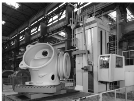
图1 安装在位于德国 Magdeburg 的 SKET 公司 由 UnionChemnitz 制造的落地镗铣床 PCR200
