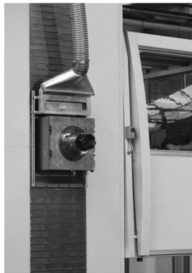
图2 高精度的静压导轨滑枕
