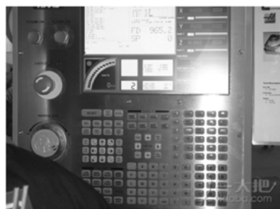
图3 禹衡光学的手动脉冲发生器应用在某国外著名机床上
