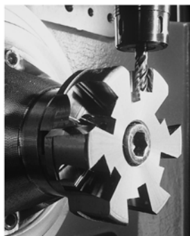
图2 LAC（负载自适应控制）决定旋转轴的转动惯量。该功能根据工件的当前转动惯量连续调整进给控制参数
