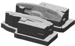
图3 利用扫描数据制作的毛坯 CrSiMnMoV 铸造镶块 + Cr12MoV 锻造镶块
