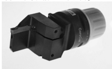
图8 山特维克可乐满的双高压冷却切槽刀
