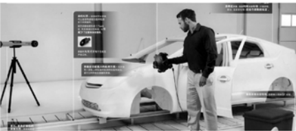
图 41 Creaform 公司的便携式三维数字扫描仪和工业级光学 CMM 3D 扫描系统
