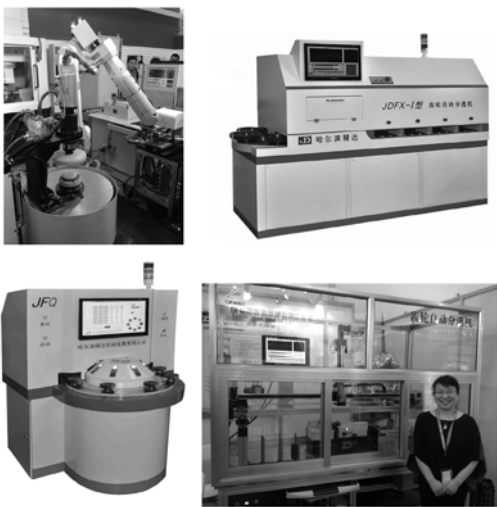
图 14 精达、智达和南二开发的机器人式，转盘式和桁架机器人式齿轮自动测量分选机
