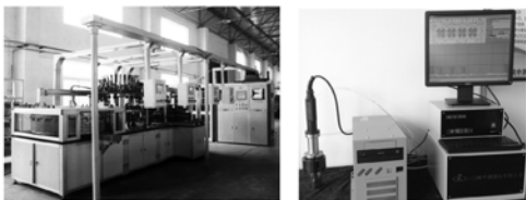
图 40 中测的多零件多品种多规格自动分选机及微机测量系统
