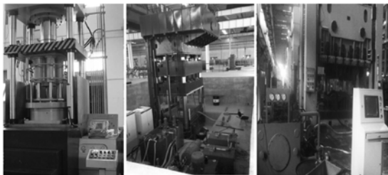
图5 550t、1050t和1600t国产板件充液成形液压机
