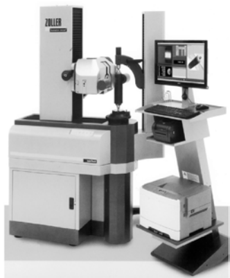
图 23 Zoller 滚刀检测仪
