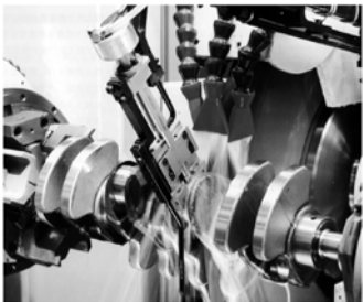
图 37 Fenar L 曲轴测量
