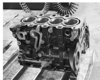
加工车间内正待进入下一道工序的 1.5TGDI 涡轮增压直喷发动机的缸体件
