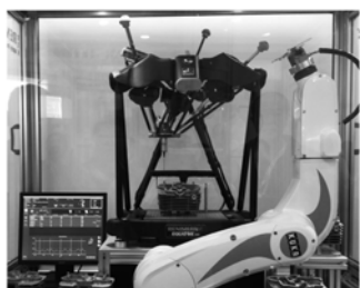
图 10 雷尼绍配备机器人的比对测量机
