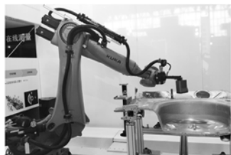
图 9 蔡司的机器人在线非接触测量
