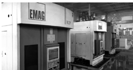
图2 埃马克为明宇重工量身定制的由3台VL 2 P联机的生产解决方案
