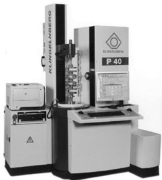
图 16 P40 齿轮中心测曲轴
