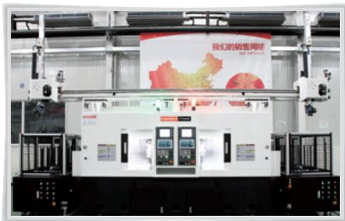
HTD450 的物流系统采用内置双机械手和双料仓配置，机内配置自动翻转装置，实现从毛坯到成品的一次性无人化加工。主机在左右两侧各设置 1 个料仓，可以根据被加工零件的节拍，对料仓功能进行灵活设置。料仓规格和容量可以根据零件规格和无人化看管时间进行配置。
