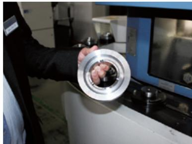
埃马克 VL 机床采用的倒立式设计让车床内的加工件获得了很好的保护，确保了加工精度的一致性以及工艺的可靠性
