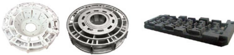
飞机机匣蜡模和钛合金零件（最薄壁厚 3.2mm）
