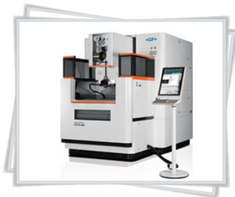
（3）专注于提高生产率。CUT E350 在设计上专注于生产率的提高，和同级别的机床相比，集成的加工工艺可使加工时间减少 18%。CUT E350 具有高切割性能，机床根据加工路径自动选择最佳的切割工艺，拐角策略自动调整切割参数，以达到尖锐的角和完美的品质细节。为了获得最佳的生产率和优化的速度、精度和表面粗糙度，CUT E350 可配专有的 AC CUT VS 电极丝，可加快切割速度，降低工件成本 20%，增加产量 28%。
