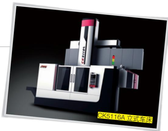
主轴采用高转速、高精度的进口主轴轴承, 并采用恒温油冷却及润滑。主轴材料采用 38CrMoAl, 经表面氮化处理并抛光, 最终硬度可达 HV900 以上。
