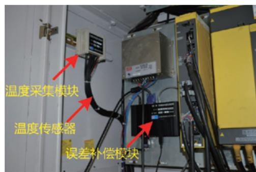
图 13 基于嵌入式计算机的热误差补偿系统
