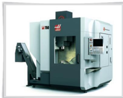
或实现轮廓铣削及复杂加工所需的 5 轴联动。该有耳转台倾斜角度区间为 +110° 至 -35°，并且能够实现 360° 旋转，创造出充足的刀具避让空间和加工大尺寸零件的能力。转台尺寸为 630mm x 500 mm，带有 T 型槽和一个的精准导向孔，便于自由安装夹具。
