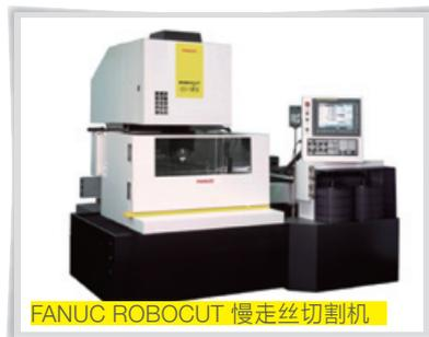
FANUC ROBOCUT 慢走丝切割机
