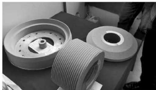
图4 山东义百度展品:螺旋锥齿轮数控磨加工专用砂轮(左)、蜗杆齿轮磨专用砂轮(中)、圆柱齿轮成型磨专用砂轮(右)
