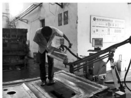
图 2 车间现场的模具测量
