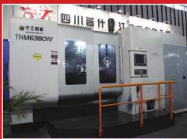
四川普什宁江机床有限公司THM6380IV 精密卧式五轴加工中心
