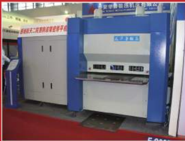
泰安华鲁锻压机床有限公司 WE43K-6×1200精密数控矫平机
