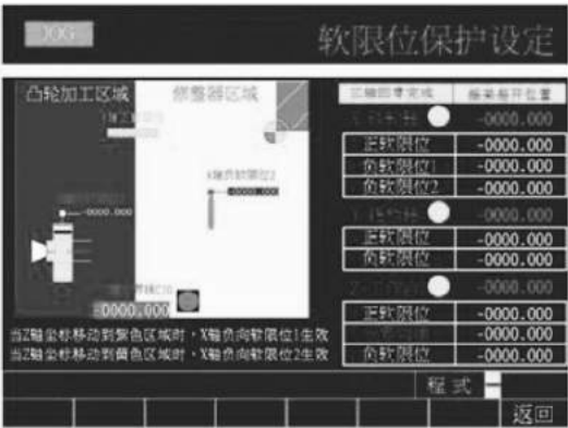
图 5 软限位保护设定图
