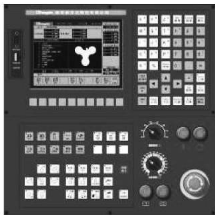
CNC-100MP 双向曲面刨床数控系统
