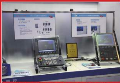
武汉华中数控股份有限公司HNC-848总线式高档数控装置
