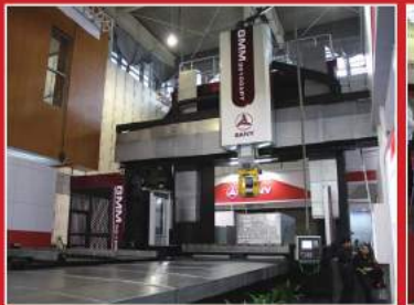
上海三一精机有限公司GMM30100APT 动梁可交换五轴龙门加工中心
