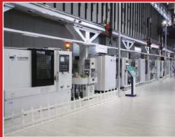
大连机床集团有限责任公司 DXHS0001活塞加工自动线
