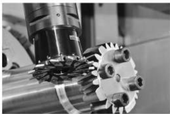
山特维克可乐满采用的 InvoMilling 齿轮制造技术——只需一把铣刀，装上标准的可转位刀片，即可生产出一个模数范围内的齿轮。
