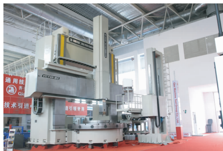
图 1 齐二机床的 VTC450-MC 立式车铣中心
