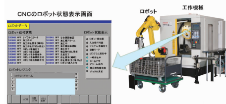
图5 用CNC画面显示机器人的状态
