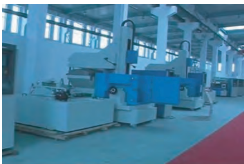
图4.5 为成都航空发动机股份有限公司研制的 多轴数控高效放电铣设备
