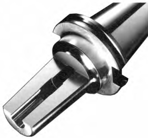
图 2 Lyndex 公司生产的收缩配合刀具夹持器的切面，它表明了夹持器设计的简单性，孔是有意做小的，所以加热时它扩大，然后冷却时它便同心地紧密抱住刀柄
