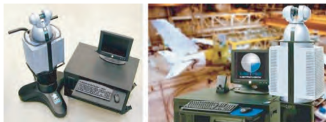
图 21 激光雷达测量仪 图 22 激光雷达在现场的应用
