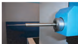
图 12 精达的万向触发数字测微头
