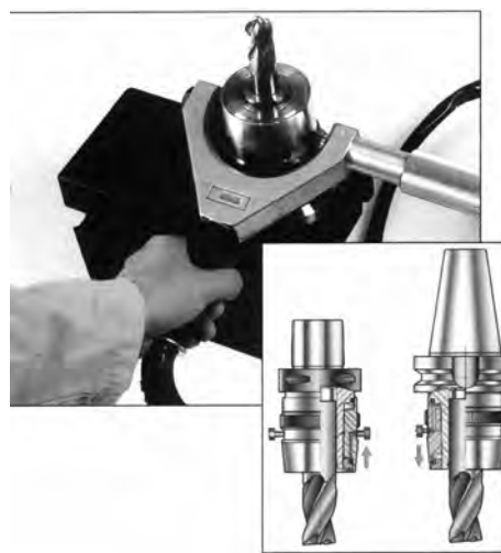
图3 有经验的用户可以在仅 20s 内更换在 Corogrip 液压机械夹头中的刀具。右下角的插图表示夹头的剖面
