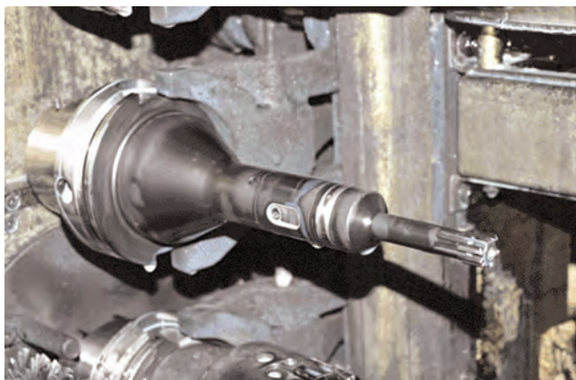
图 2 来自 Dihart 的 Reamax TS 铰刀具有有调整时间短的特点。由于完全不需要调整，可获得极好的重复精度
