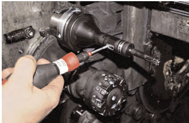
图 3 只需在机床上更换铰削头就可以改变用途，即可使用不同几何形状的切削刃、刀具材料和涂层，实现柔性加工
