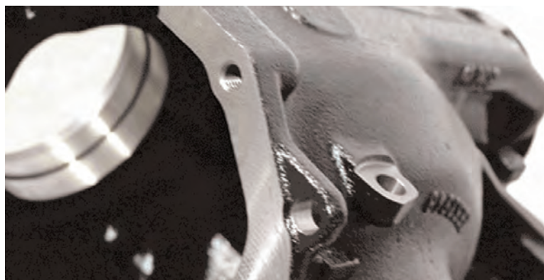
图1 汽车后轴齿轮箱的分度孔用于保证后序加工和装配的严格公差
