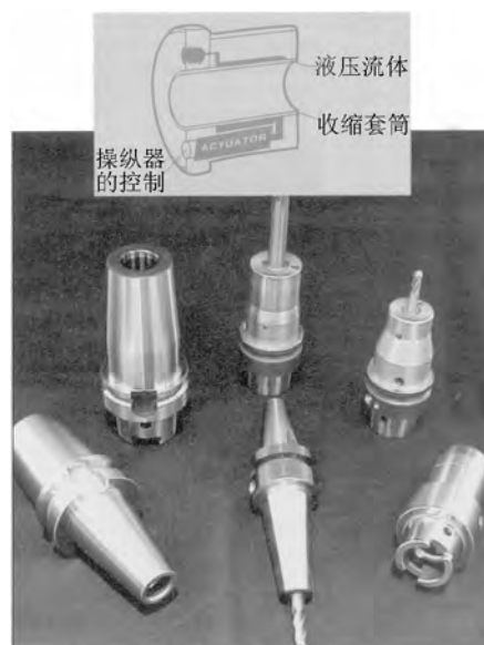
图 1 诸如 Hydro-lock 公司生产的液压夹头,具有自然平衡,好的同心度和达 21MPa 的夹紧压力。图的上方是工作原理图:用户调节操纵螺杆以移活塞。活塞压缩液压流体,流体压缩薄内套以夹住刀柄
