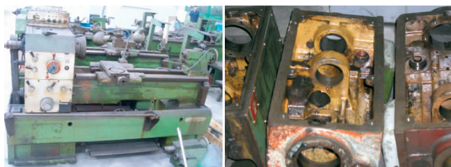
图5 客户企业待再制造的机床 图6 废旧机床拆卸工序
