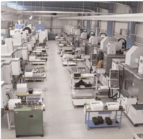
图 1 在 PTF（Pr. zisionsteilefertigung Steffen Pfüller）公司 48m 长的车间内共有 38 台瑞士 Fehlmann 公司制造的铣床，执行三班制少人化精密加工任务。
