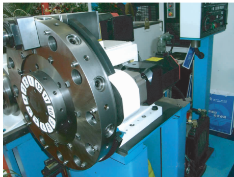
图 16 APEX 减速机在动力刀架上的应用
