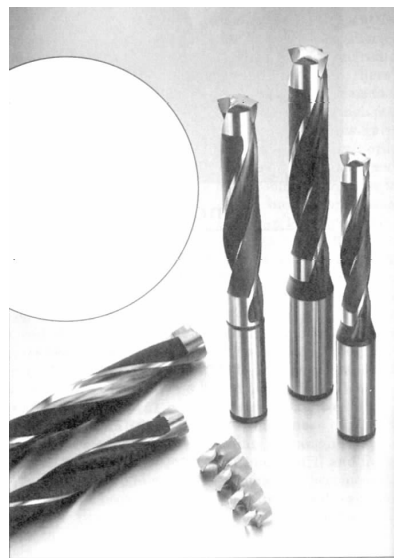
图4 Kennametal 公司生产的 KSEM 钻头的特点是可以选择刀片等级的模块化刀片设计。在钻头体中的刀片锁紧机构可防止切屑阻塞。切屑在硬质合金刀片上形成,而不在钢的刀具体上形成,这样可延长刀具寿命。即使在进给速率高的情况下,本设计也是稳定的和精确的
