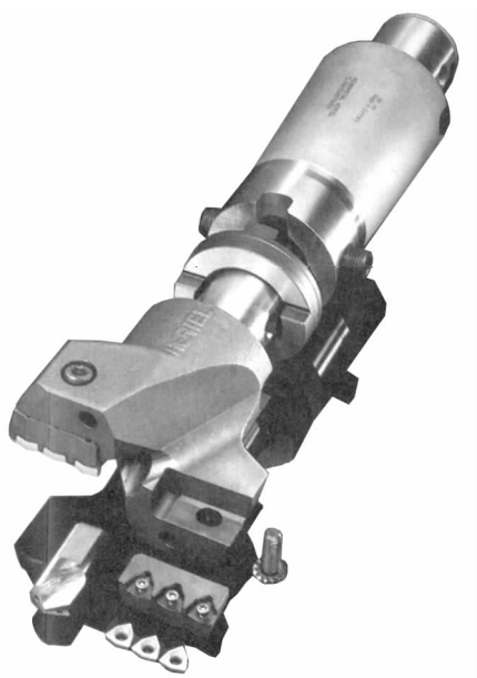
图2 诸如 Kennametal 公司生产的一类钻深孔系统可以钻孔径为 44.45mm ~ 170mm 的孔,深度为孔径的 8 倍
