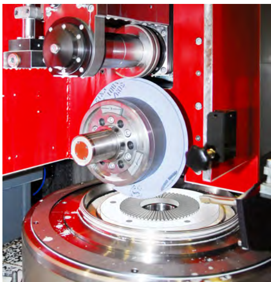
图1 端面齿的卧式平面磨削
