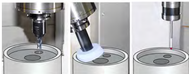
图3 在一个加工过程中完成镗孔, 磨削和测量, 位置公差小于 4\mu\text{m}
