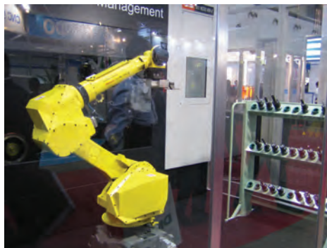
图 5 机器人向刀库装刀
