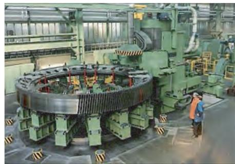
图12 希斯庄明的16米数控滚齿机 RF-CNC160
