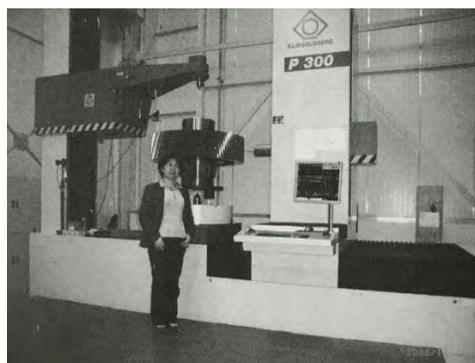
图4 P300齿轮测量仪
