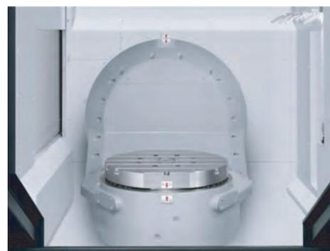
图11 最新研发的5轴工作台
