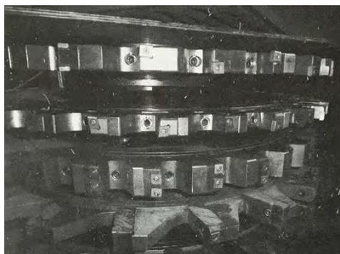
图3 数控转子槽铣床和几个铣刀盘
