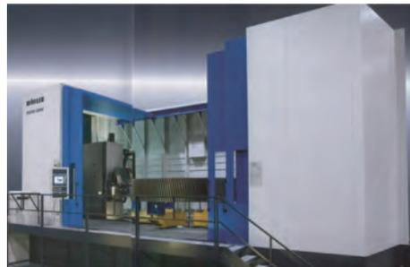
图4 RAPID6000数控成形砂轮磨齿机
