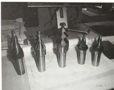
图2 不同尺寸规格的枞树型成形铣刀
