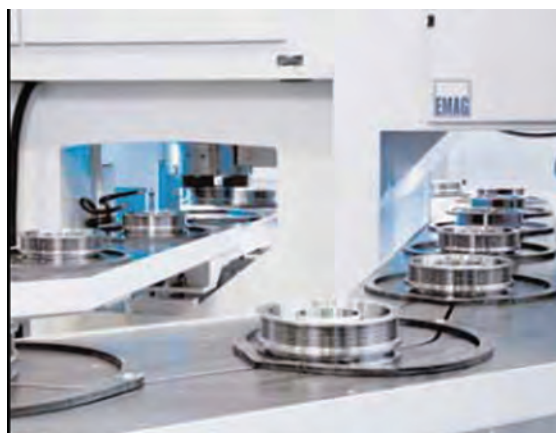
图 5 快速上、下料：工件由传送带送到拾取工位，传送带配有自适应工件传送支架，可以最大限度地减少不同直径工件的重调时间。
