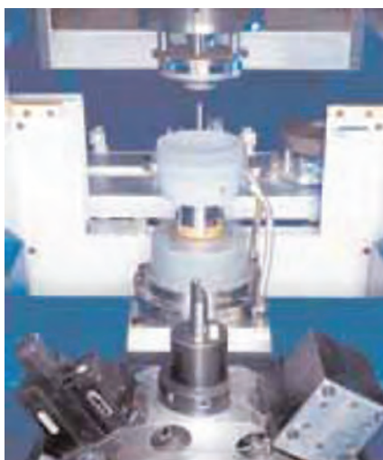
图 4 在 VSC 400 Modular 上，可以将车削和磨削作业组合到一台机床上，一次装夹完成汽车齿轮箱淬硬零件的车、铣、磨全部加工，从而达到很高的精度标准。
