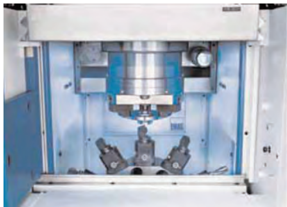
图 3 装备精良：可以安放 12 把刀具，若需要的话，可以使用 12 把动力刀具，如钻头和铣刀。一次装夹可以完成多工序加工。多种转塔刀架可使 VSC 400 Modular，以最佳状态满足生产要求。
