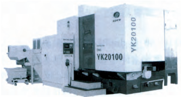
图5 YK20100全数控螺旋锥齿轮磨齿机
