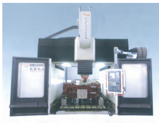
图7 GMC2000H/2五轴联动横梁移动龙门加工中心
