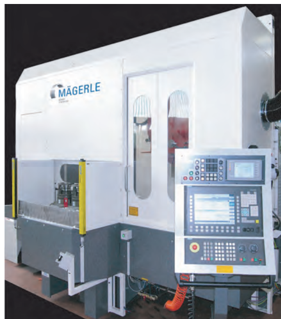
图 2 Mägerle 公司的 L 系列轮廓磨床，一次行程可完成宽度达 320mm 型面的全部磨削
