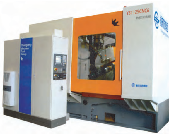
图11 Y31125CNC6数控滚齿机
