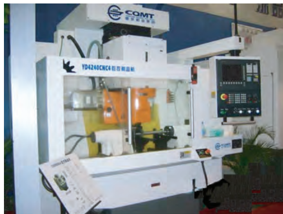
图20 YD4240CNC4数控剃齿机
