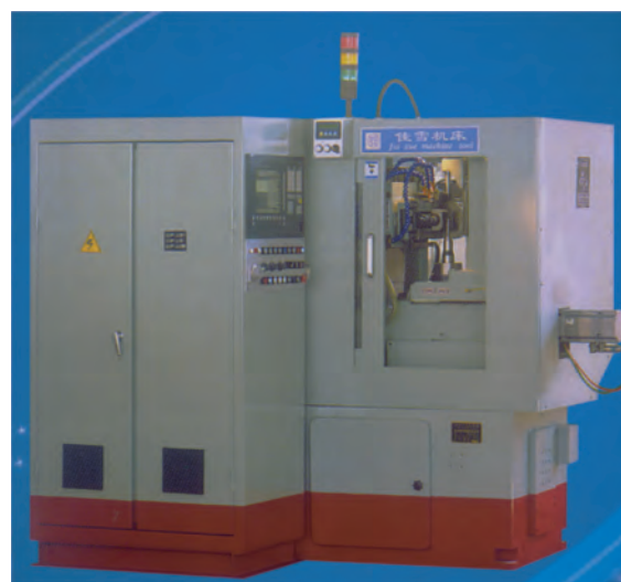
图14 Y3112CNC型高效精密数控滚齿机
