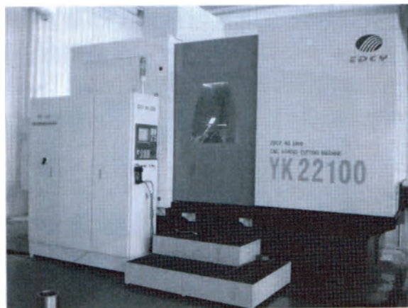
图6 YK22100全数控螺旋锥齿轮铣齿机
