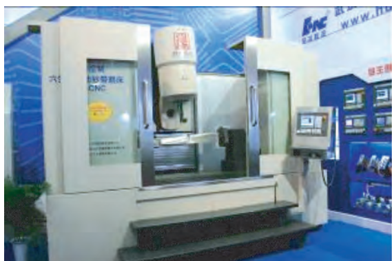
九轴六坐标联动数控TX-6数控砂带磨削抛光机床
