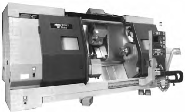
森精机公司的 MT2500SZ 9 轴控制铣-车中心
