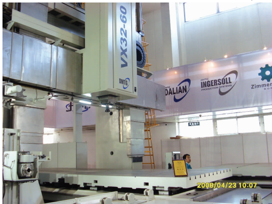
图2 VX32-60动梁龙门加工中心
