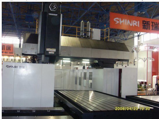
图1 VM2050P定梁双交换台龙门加工中心
