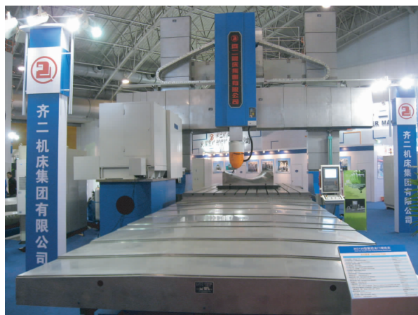
图1 XK2130型数控龙门镗铣床
