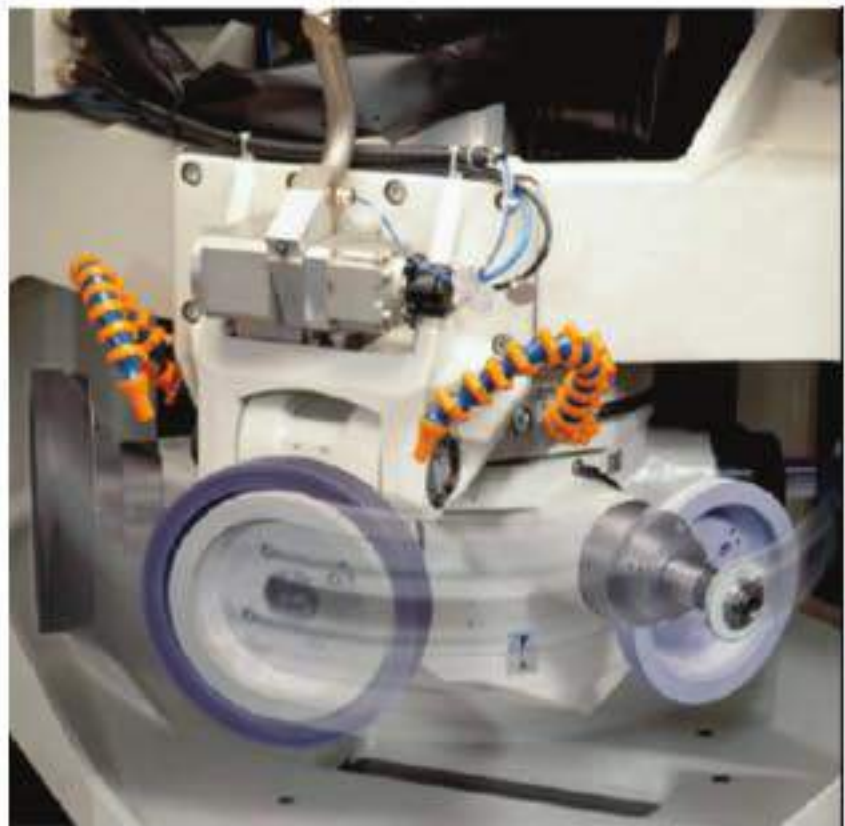
图 1 Ewamatic line. 配有六根主轴，以便腐蚀/磨削复合加工复杂刀具
