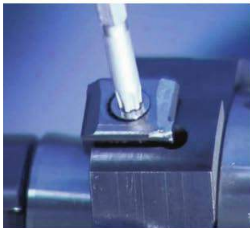
图2 由于刀片是装在刀位上磨削的，切削刃的位置是精确确定的，在刀片在其刀座上转位后，仍能保证达到要求的加工精度和表面质量
