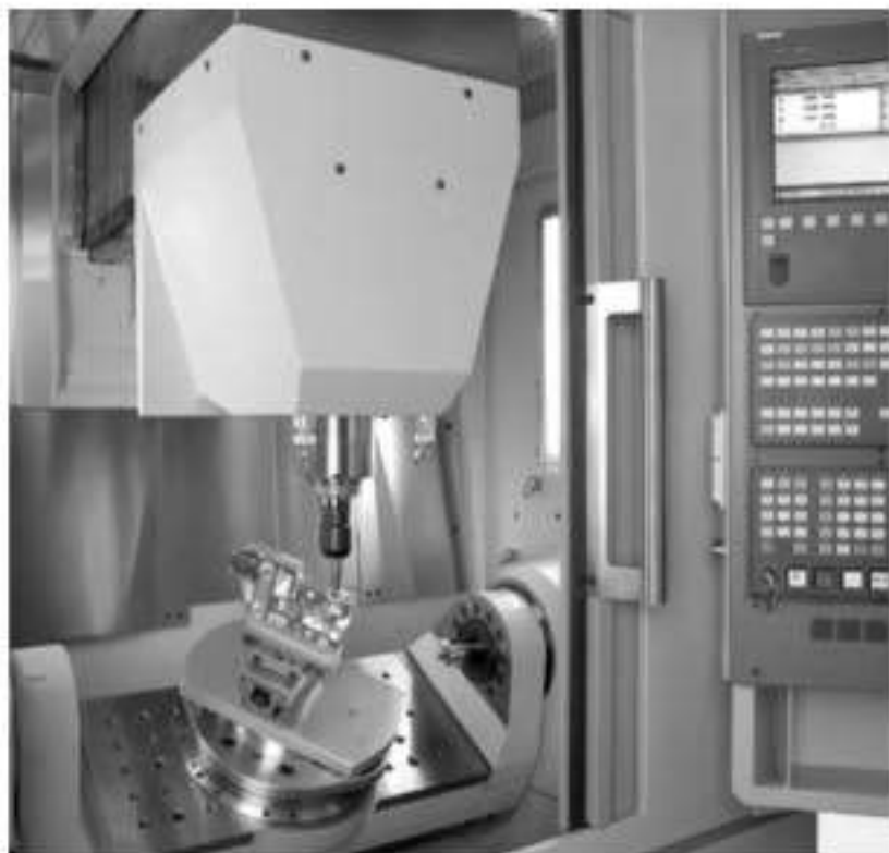
图 1 高性能：FZ 12K S 五轴加工中心 X (550 mm)、Y (400 mm)、Z (360 mm) 轴最大运动速度可达 75 m/min
