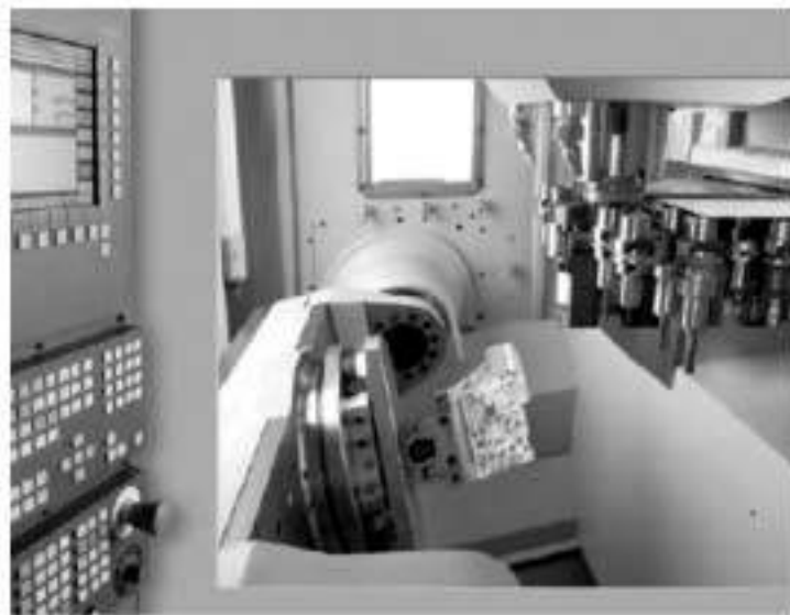
图 2 宜人化：由于采用大型侧视窗和回转操控台，机床操作员对一切情况都能一目了然
