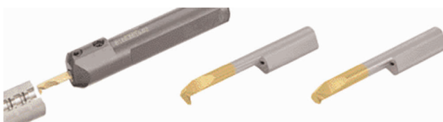
图 3 固定销内径用 Horn Supermini 车刀加工到 5.65mm。机床加工效率的提高是因为采用了这种几何形状经过优化，表面光滑并有新型超氮涂层的刀具
