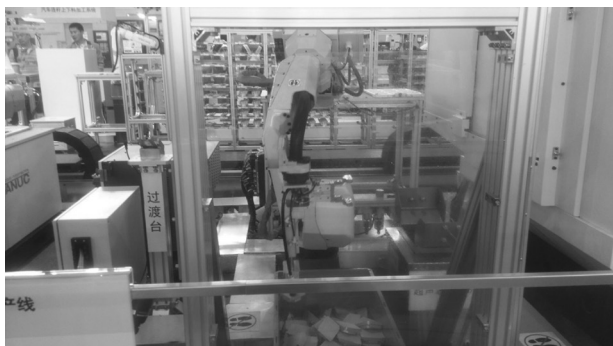
图8 机器人正在从摆放杂乱无章的零件中取件
