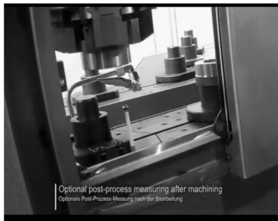
图4 探针检测工件尺寸
